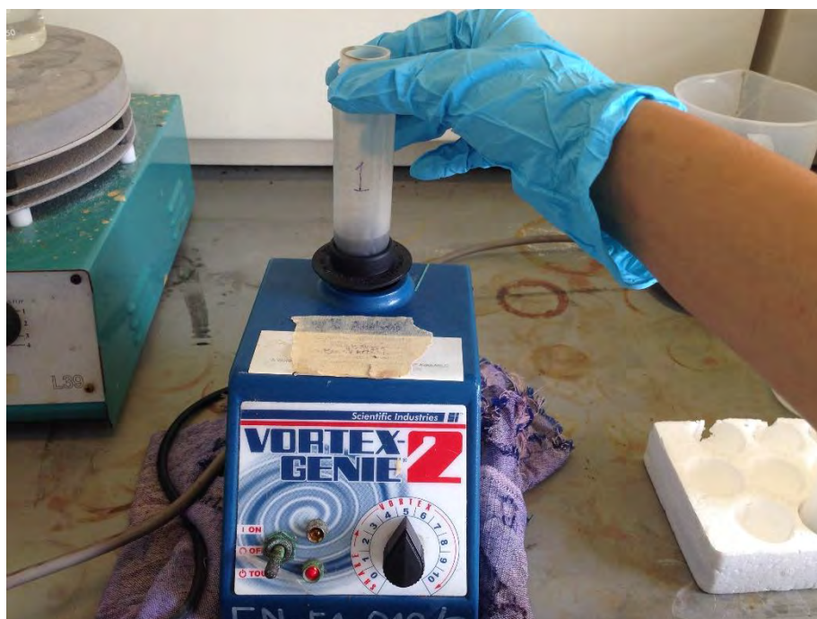
รูปที่ 2-6 ขั้นตอนการปั่นผสมโดยใช้เครื่องผสมสารละลาย
