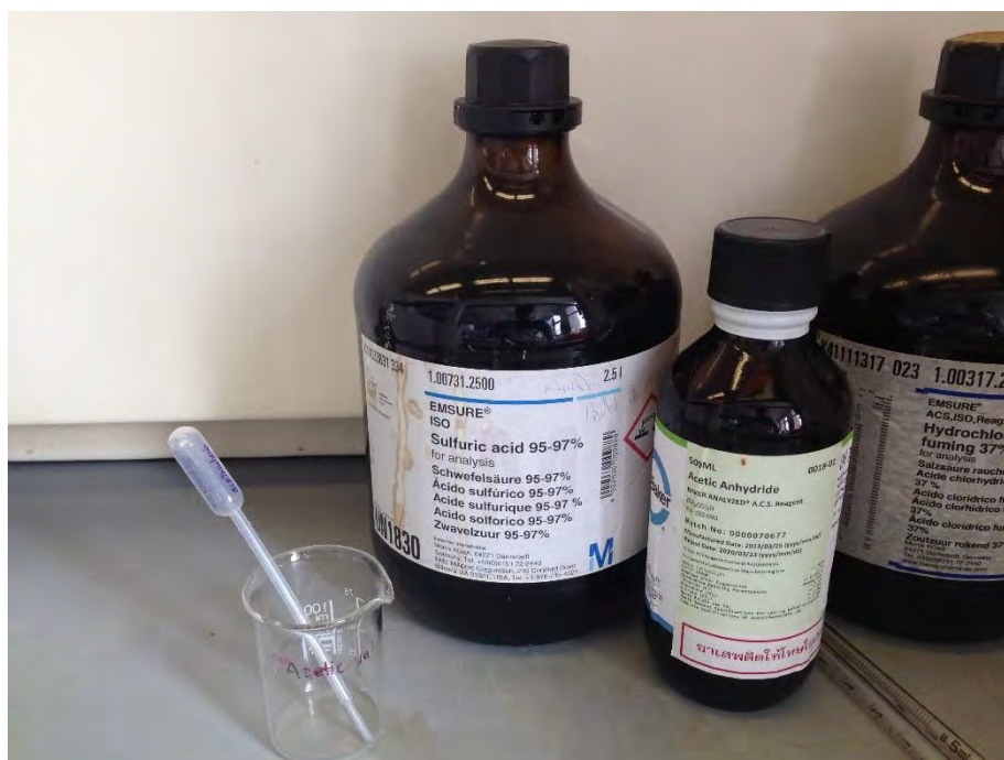
รูปที่ 2-8 ตัวอย่างกรดซัลฟิวริกเข้มข้น (ซ้าย) กับอะซิติกแอนไฮไดรด์ (ขวา) โดยจะถูกนำมาผสมกันในอัตราส่วน 1:9
