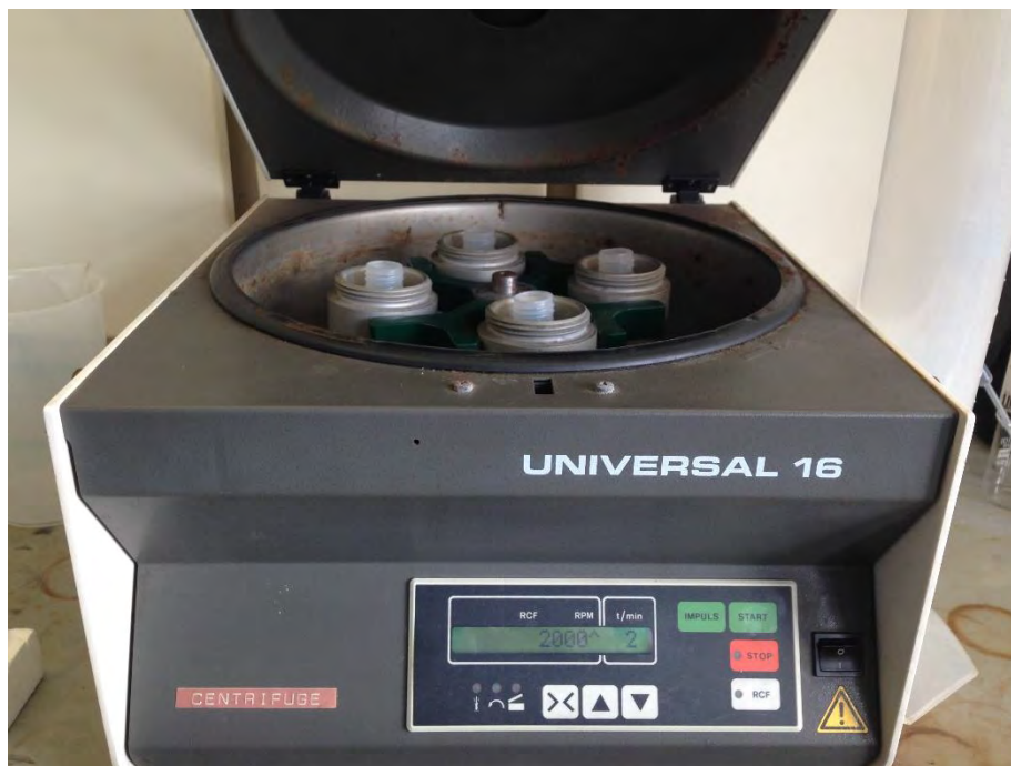
รูปที่ 2-5 ขั้นตอนการปั่นแยกโดยใช้เครื่องปั่นแยกที่ความเร็ว 2,000 รอบต่อนาที
