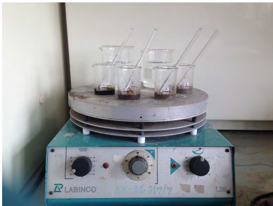
รูปที่ 2-3 ขั้นตอนการละลายตะกอนด้วยโพแทสเซียมไฮดรอกไซด์บนเครื่องให้ความร้อน เพื่อให้ตะกอนไม่จับตัวกัน
