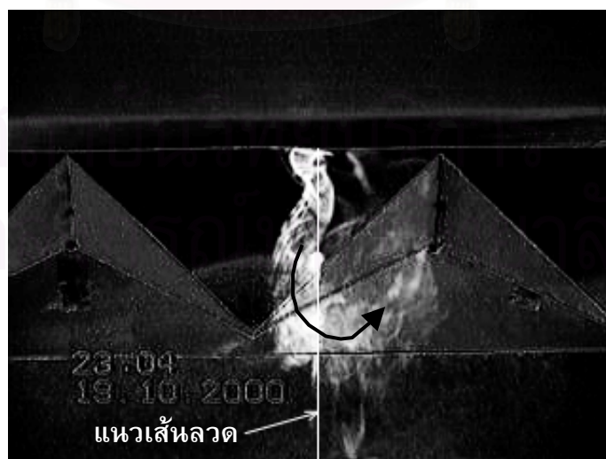
รูปที่ 5.23 ภาพด้านท้าย (End view) แสดงการไหลของอากาศที่ตำแหน่ง ใกล้ปากทางออกของเจ็ท : (ก) L000 (ข) L224 (ค) L240
