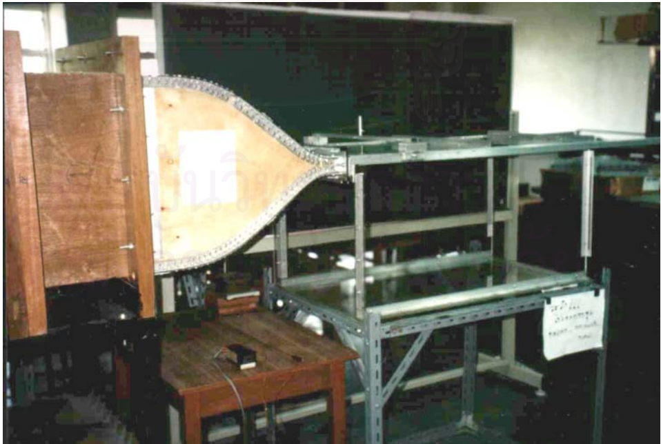
รูปที่ 4.4 ภาพแสดง Contraction และห้องทดลอง (Test section)
