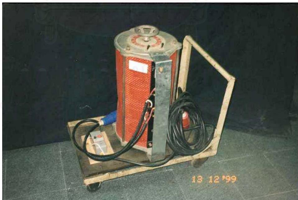
รูปที่ 4.6 ภาพแสดง Variac ขนาด 10 kVA ที่ใช้ในการปรับอุณหภูมิ
