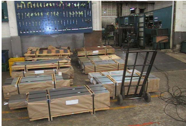
รูปที่ 3.13 ภาพแสดงที่เก็บแผ่นเหล็กทำปลอก
