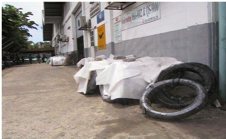
รูปที่ 3.12 ภาพแสดงขดลวดทำสปริงวางกองหน้าโรงงานรอขนย้ายเข้าแผนกสปริง
