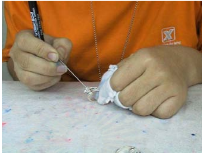
รูปที่ 4.5 การซ่อมแซมโดยวิธีหยอดกาวที่ด้านข้างอัญมณี
