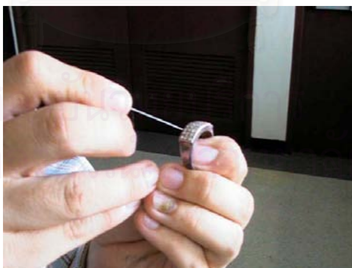
รูปที่ 4.4 การใช้เข็มทิ่มอัญมณีเพื่อดูว่าเม็ดไหนหลวม
