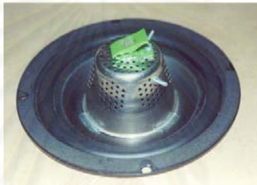
รูปที่ 5.5 อุปกรณ์กำเนิดความถี่พร้อมฐานยึดแหวน
