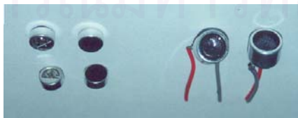
รูปที่ 5.6 ไมโครโฟนแบบ Condenser microphone และ Ultrasonic
