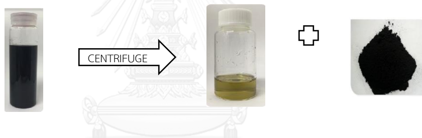
ภาพที่ 4.11 ผลิตภัณฑ์เหลว รวมทั้งของแข็ง(คาร์บอน)หลังกระบวนการแยก
