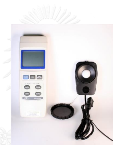
ภาพที่ 3. 1 เครื่องวัดความส่องสว่าง Lux meter รุ่น LT Lutron LX-1108
