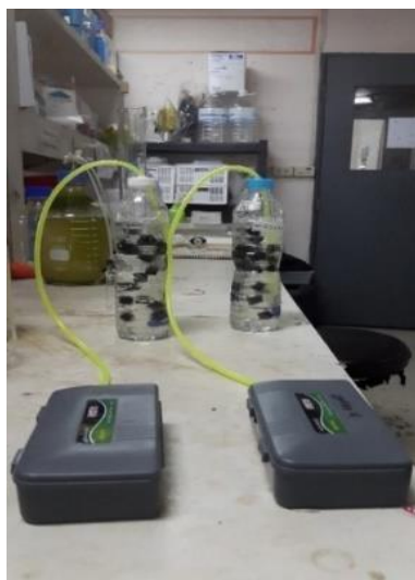
รูปที่ 3.9 การเติมอากาศก่อนนำตัวกรองชีวภาพไปตรวจสอบการเกาะติดของจุลชีพบนพื้นผิวด้วย กล้องจุลทรรศน์อิเล็กตรอนแบบสแกน
