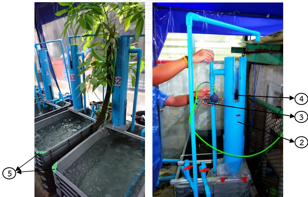
① ถังกรอง ② ท่อพีวีซีภายนอกเส้นผ่านศูนย์กลาง 6 นิ้ว ③ ตะแกรงพลาสติก และขอบยางพลาสติก ④ ตัวกรองชีวภาพ BCN-012 ⑤ หัวทรายเติมอากาศ รูปที่ 3.11 แผนภาพการหมุนเวียนน้ำและการติดตั้งอุปกรณ์สำหรับระบบตัวกลางจมตัว
