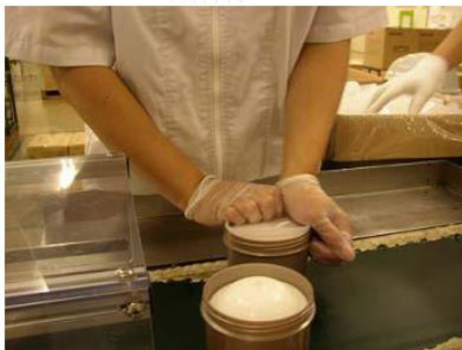
รูปที่ 41 วิธีการปิด Inner Cap โดยพนักงาน
