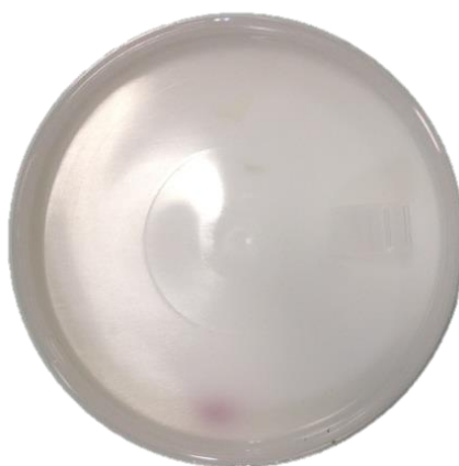
รูปที่ 46 ตัวอย่างชิ้นงานที่เกิดจุดสีชมพู
