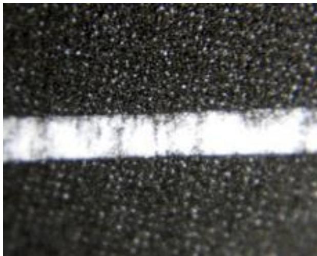
ภาพที่ 4.8 ส่วน Geometric Diagnosis Patch บนงานพิมพ์ที่น้ำในระบบทำขึ้น ไม่เพียงพอต่อความต้องการของระบบพิมพ์
