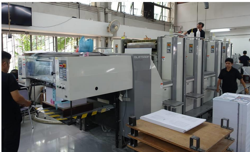
ภาพที่ 3.1 แท่นพิมพ์ Sakurai รุ่น OL475SDP 4 ยูนิต
