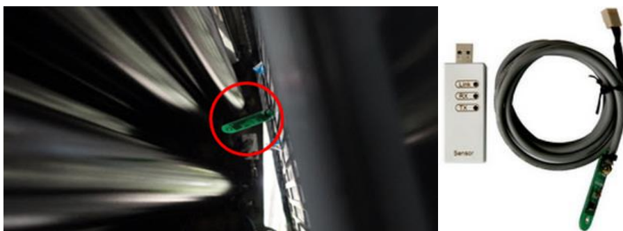
ภาพที่ 3.5 จุดติดตั้งหัววัดค่าความอุณหภูมิและความชื้นสัมพัทธ์ของอากาศบนแท่นพิมพ์ พร้อมกับสายเชื่อมต่อชนิด USB Type A
