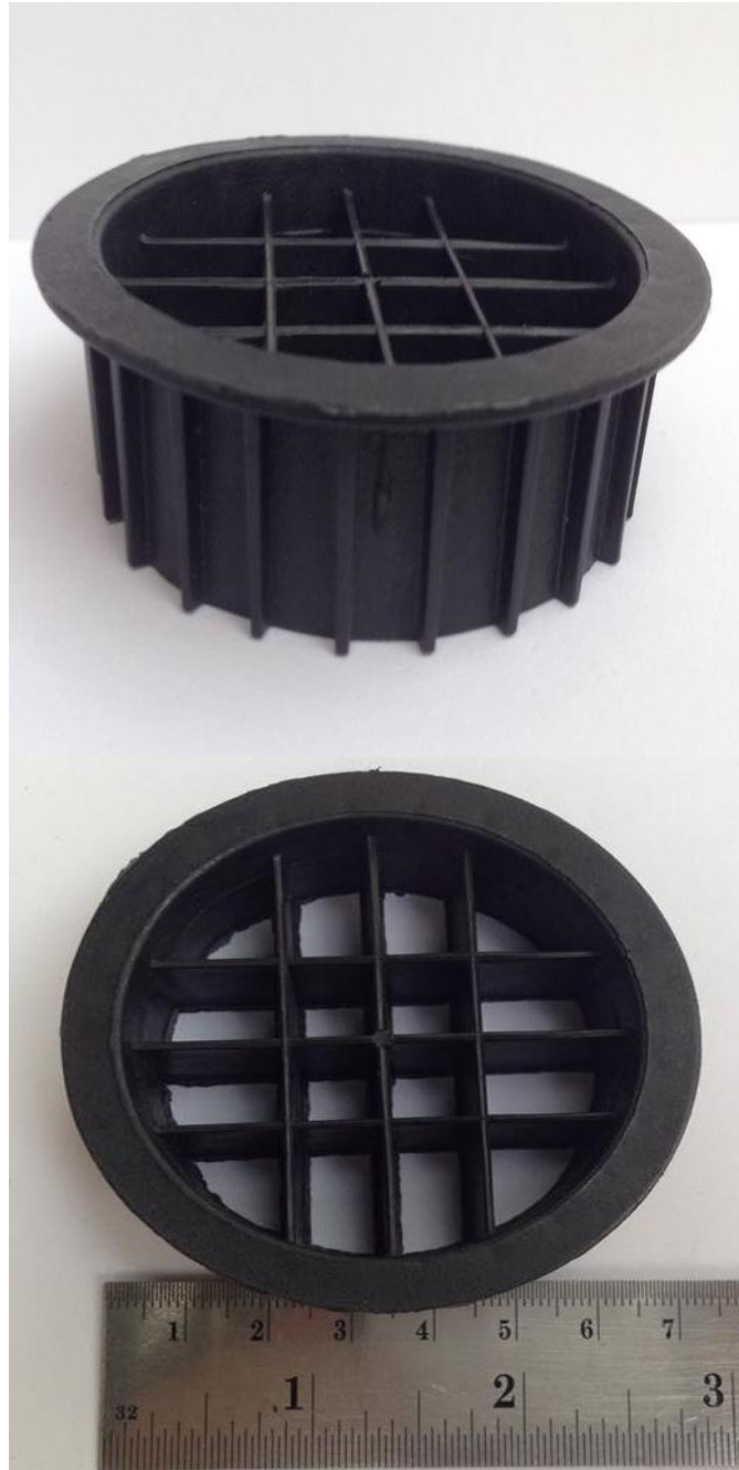
รูปที่ 3.1 ตัวกลางพลาสติก รุ่น R-190 Random Flow Media ของบริษัท AQUA
