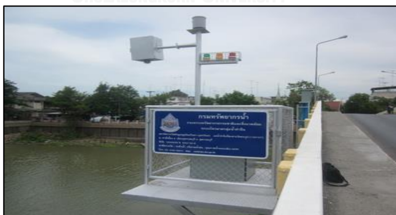
รูปที่ 2.11 เครื่องวัดระดับน้ำแบบโทรมาตร ที่มา : (วิษญ์ ศรีวงษา, 2556)
