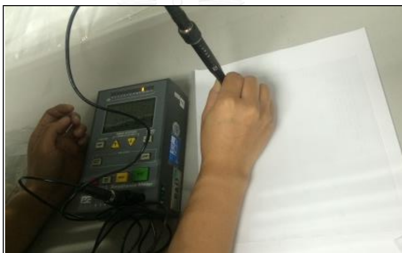
รูปที่ ข5 วัดค่าความต้านทานไฟฟ้าที่ผิวโดยเครื่องวัดความต้านทานพื้นผิว
