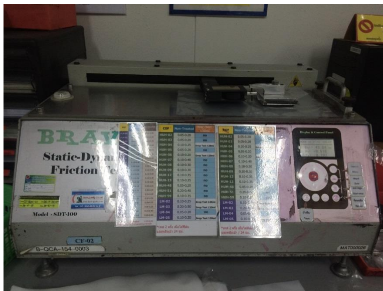
รูปที่ ข1 เครื่องทดสอบสัมประสิทธิ์แรงเสียดทานของพลาสติกฟิล์ม ที่มา : โรงงานกรณีศึกษา
