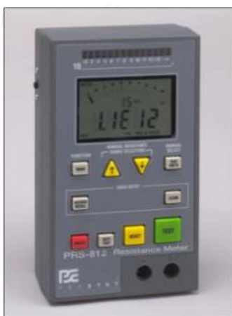
รูปที่ 4.5 เครื่องวัดความต้านทานพื้นผิว รุ่น PRS-812
