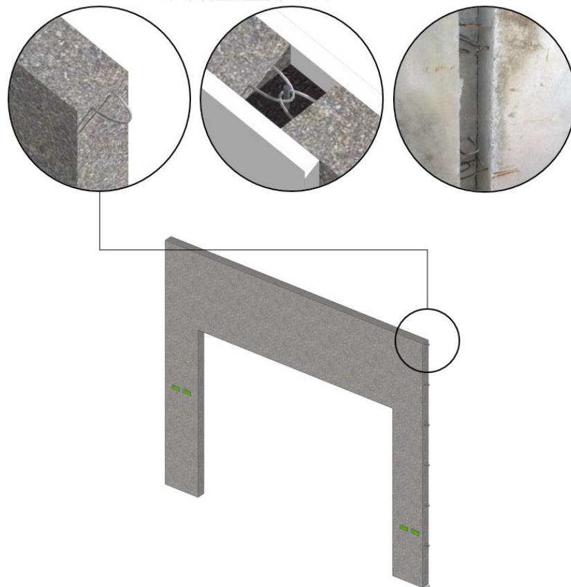
ภาพที่ 57 ภาพจำลองรอยต่อระหว่างชิ้นส่วน โครงการแฟมิลี ซิตี้ พานทอง
