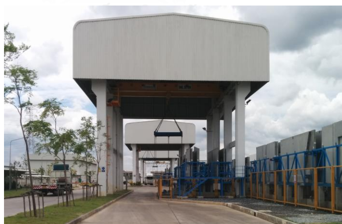
ภาพที่ 6 การขนส่งชิ้นส่วนคอนกรีตสำเร็จรูป
