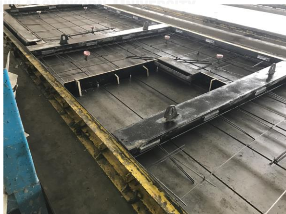
ภาพที่ 65 ตัวอย่างชิ้นส่วนที่ใช้ไม้แบบช่วยในการผลิต
