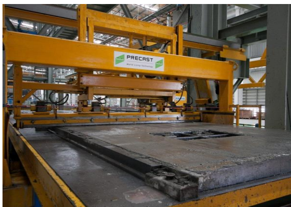
ภาพที่ 78 การปาดหน้าคอนกรีตอัตโนมัติ ที่มา บริษัท พฤษา เร็ลเอสเตท จำกัด(มหาชน)
