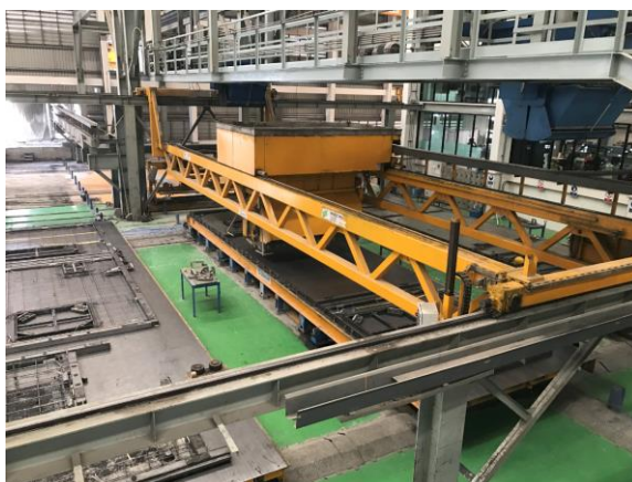
ภาพที่ 76 เครื่องเทคอนกรีตอัตโนมัติ
