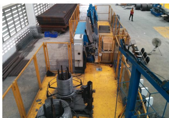
ภาพที่ 95 เครื่องจักรนำเหล็กม้วนมายืดตรงและตัดตามขนาดอัตโนมัติ
