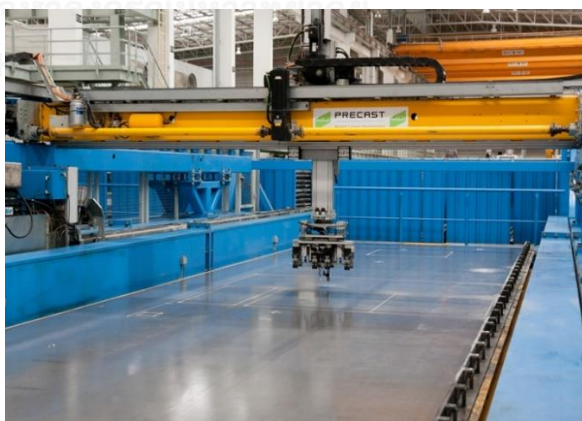
ภาพที่ 68 เครื่องขีดเส้น กำหนดตำแหน่งชิ้นส่วนอัตโนมัติ ที่มา บริษัท พฤษา เร็ลเอสเตท จำกัด(มหาชน)
