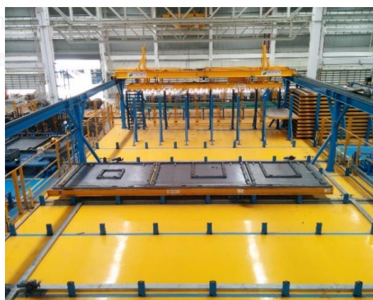
ภาพที่ 98 เครื่องจักรนำเหล็กเสริมที่เตรียมไว้มาวางบนโต๊ะแบบอัตโนมัติ
