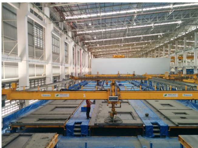
ภาพที่ 4 การผลิตชิ้นส่วนคอนกรีตสำเร็จรูป
