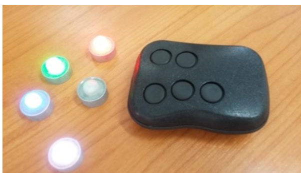
รูปที่ 10 ภาพแสดงของจุดบอกตำแหน่งแบบมีแสงสว่าง (Active Marker)
