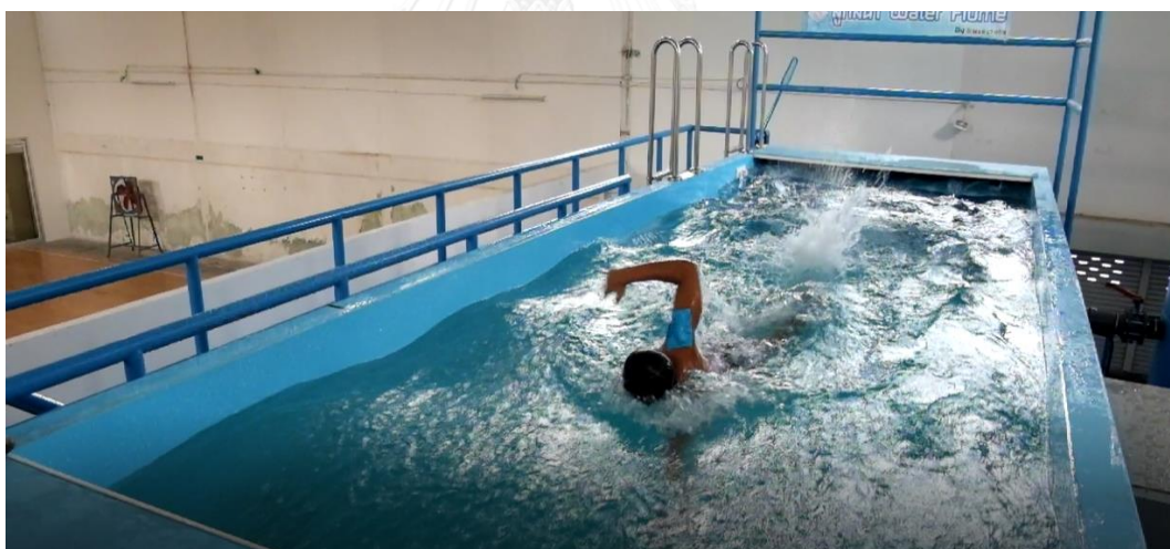
รูปที่ 33 นักกีฬาทำการทดสอบว่ายน้ำท่าครอว์ลด้วยความเร็ว 1.5 m/ ทั้งหมด 3 เซต เซตละ 20 สโตรค
