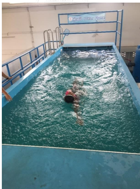
รูปที่ 29 เปิดความเร็วน้ำที่ 1.0 m/s เพื่อให้ นักกีฬาทำการ Warm Up และทำความคุ้นเคยกับ Flume
