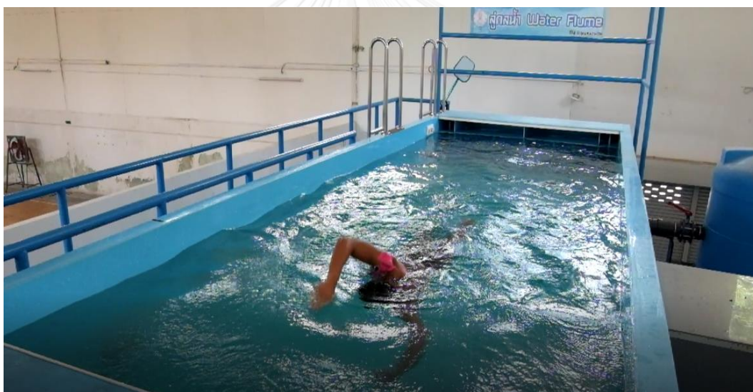
รูปที่ 31 นักกีฬาทำการทดสอบโดยว่ายน้ำท่าครอว์ลด้วยความเร็ว 0.5 m/s ทั้งหมด 3 เซต เซตละ 20 สโตรค
