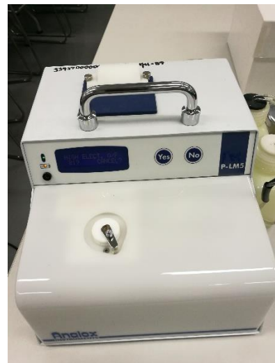
เครื่องวัดระดับแลคเตทในเลือด รุ่น Analox-LM5
