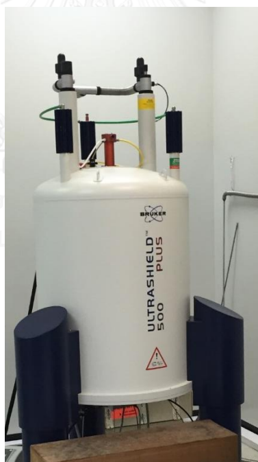
รูปที่ 55 เครื่อง ^1\text{H} NMR ความถี่ 500 MHz
