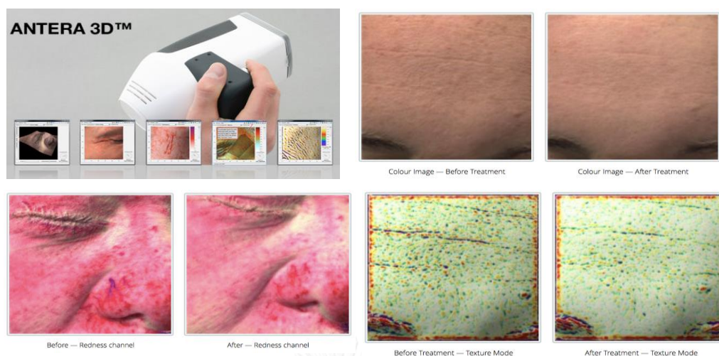
รูปที่ 3 แสดงเครื่องมือตรวจสอบสภาพผิว (Antera 3D ® ) และตัวอย่างการแสดงผลของเครื่องมือเมื่อทำการวัดค่าดัชนีความขรุขระและดัชนีความแดงของผิว
