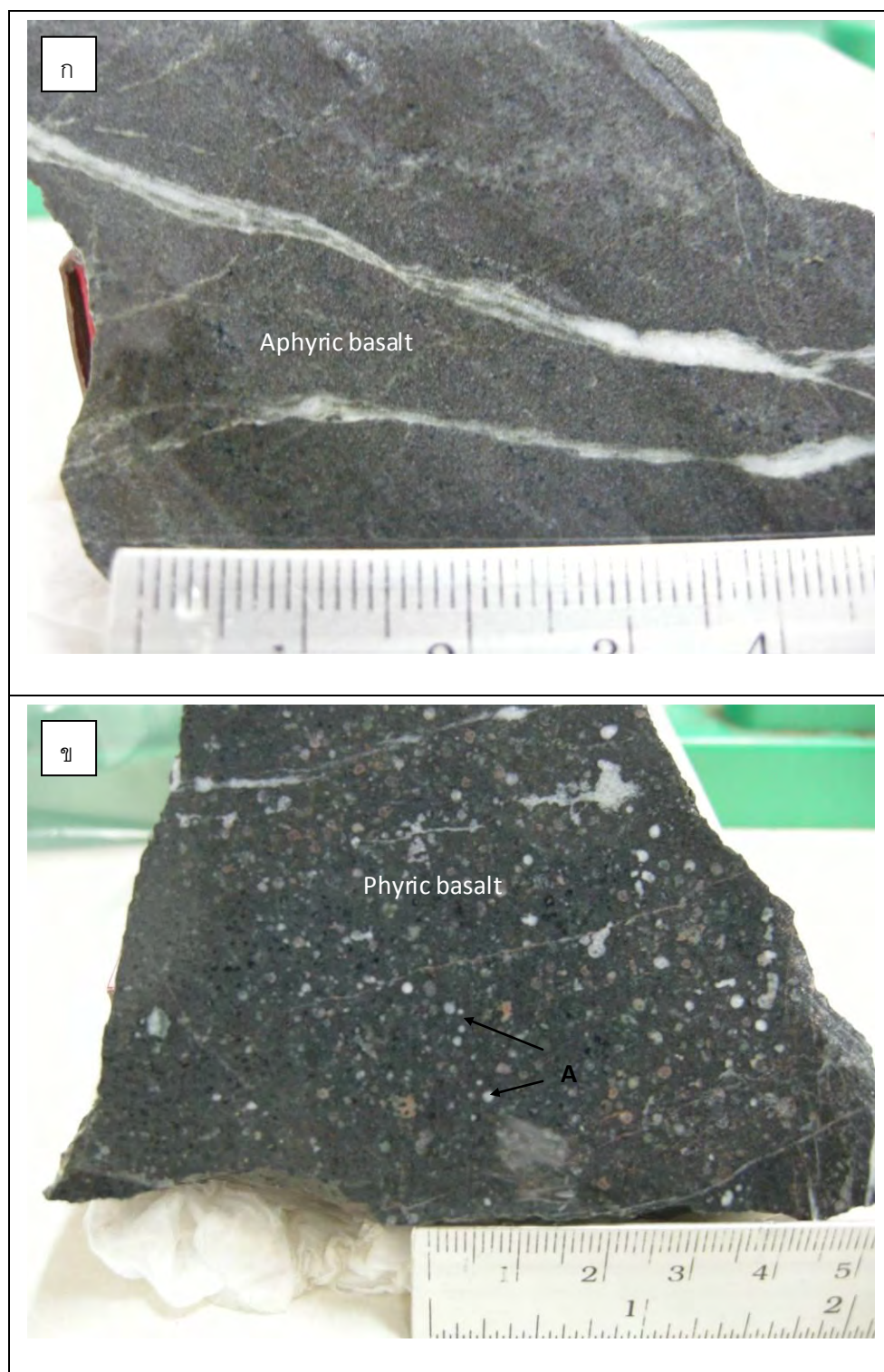
รูปที่ 4.1 แผ่นหินขัดเรียบของหินบะซอลต์ ก) Aphyric basalt ที่มี calcite vein ตัดผ่านเนื้อหิน ในตัวอย่าง PO-03 และ ข) Phyrlic basalt แสดงเนื้อหินแบบ amygdaloidal (A) ในตัวอย่าง NO-08
