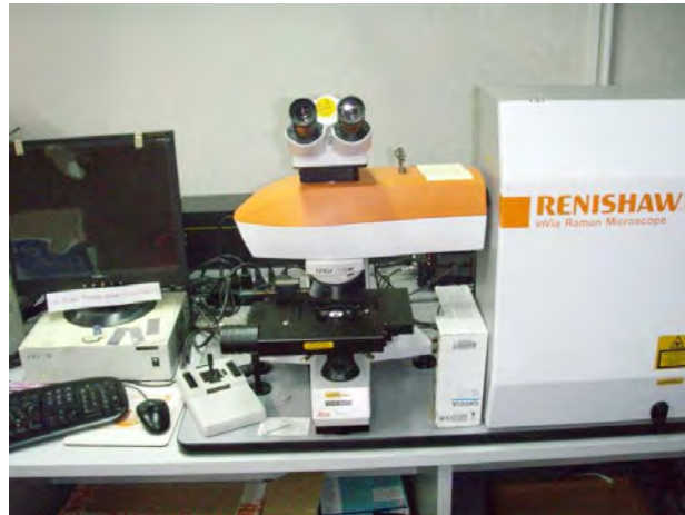
รูปที่ 2.5 Laser Raman Spectroscopy (Model Invia Raman microscope) ของ สวอ. ใช้สำหรับการศึกษาคั้งนี้
