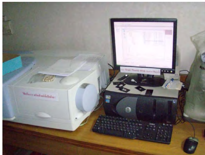
รูปที่ 2.3 (UV-VIS-NIR) Spectrometer (Model U-4001) ของ สวอ. ที่ใช้สำหรับการศึกษาในครั้งนี้
