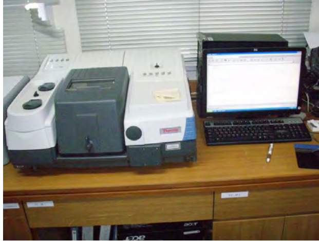
รูปที่ 2.4 Fourier Transform Infrared (FTIR) Spectrometer (Model NEXUS 670) ของ สวอ.ที่ใช้สำหรับการศึกษา
