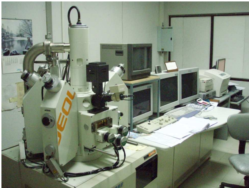
รูปที่ 2.7 เครื่อง Electron Probe Micro-Analyzer (JEOL model JXA-8100) ที่ใช้สำหรับการศึกษาในครั้งนี้
