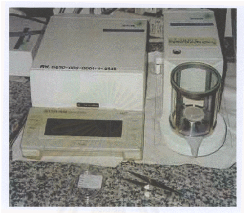
รูปที่ 3.11 การชั่งน้ำหนักกระดาษกรองเก็บตัวอย่างฝุ่น
