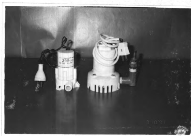
รูปที่ ก-6.4 เครื่องสูบน้ำขนาด 300 แกลลอนต่อชั่วโมง (ซ้าย) และ 500 แกลลอนต่อชั่วโมง (ขวา)
