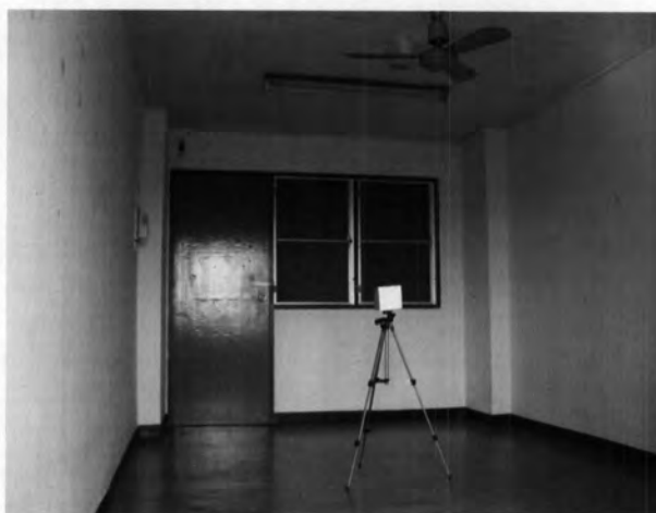
รูปที่ 3.36 แสดงการติดตั้งกล่องที่ห่อหุ้มด้วยฟอยล์ครอบเครื่อง HOBO และหัวตรวจวัด อุณหภูมิบริเวณด้านล่างฝ้าเพดานและหัวตรวจวัดอุณหภูมิภายในห้องกรณีศึกษา
