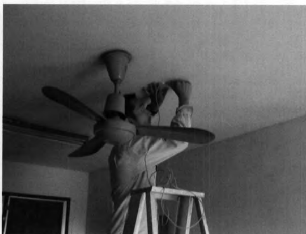
รูปที่ 3.34 แสดงการติดตั้งหัวตรวจวัดอุณหภูมิบริเวณด้านล่างฝ้าเพดาน ภายในห้องกรณีศึกษา
