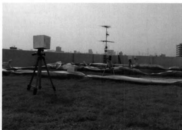
รูปที่ 3.37 แสดงการติดตั้งกล่องที่ห่อหุ้มด้วยฟอยล์ครอบเครื่อง HOBO สำหรับชุดหัวตรวจวัด อุณหภูมิบริเวณด้านบนหลังคา คสล.และหัวตรวจวัดอุณหภูมิภายนอกห้องกรณีศึกษา
