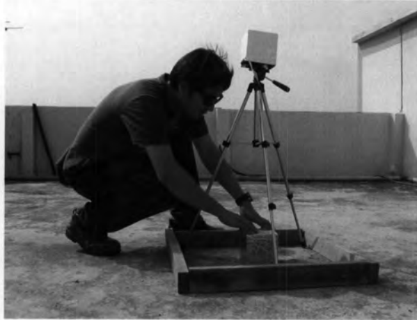
รูปที่ 3.39 แสดงการติดตั้งกล่องที่ห่อหุ้มด้วยฟอยล์ครอบเครื่อง HOBO และหั่วตรวจวัด อุณหภูมิบริเวณด้านบนหลังคา คสล.ห้องกรณีศึกษาห้องที่ 1
