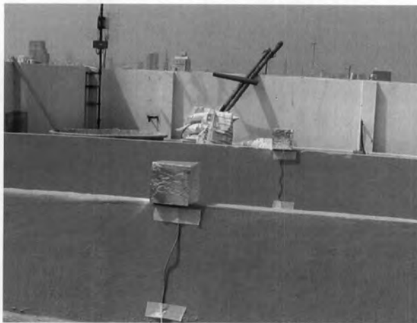
รูปที่ 3.25 แสดงการติดตั้งเครื่อง HOBO ภายในกล่องที่ห่อหุ้มด้วยฟอยล์ ด้านบนหลังคา คสล. ห้องชั้น 6 ของห้องกรณีศึกษา
