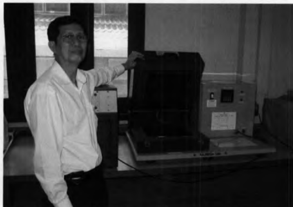
รูปที่ 3.40 แสดงเครื่องมือ TC B480 ซึ่งใช้ประเมินหาค่า THERMAL CONDUCTIVITY ของ วัสดุ (ภาควิชาวิศวกรรมเครื่องกล คณะวิศวกรรมศาสตร์ จุฬาลงกรณ์มหาวิทยาลัย, 2551)
