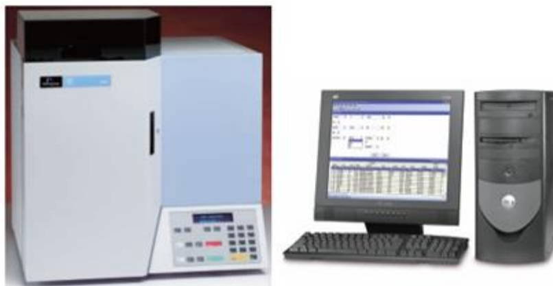
รูปที่ 3.13 Elemental analyzer (EA) (CHNS/O Analyzer) ยี่ห้อ Perkin Elmer รุ่น PE2400 Series II
