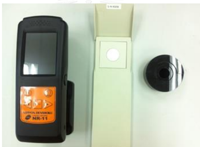
รูปที่ 3.16 Color checker ยี่ห้อ Nippon Denshoku รุ่น NR-11
