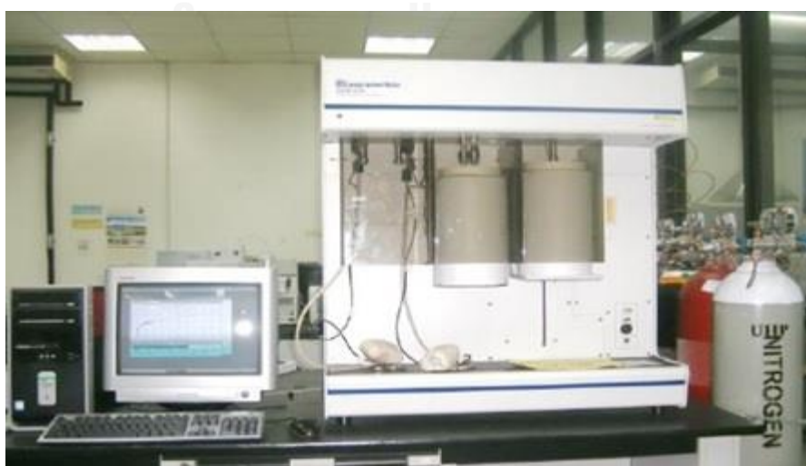
รูปที่ 3.22 Surface area and porosity analyzer ยี่ห้อ Micromeritics รุ่น ASAP 2020
