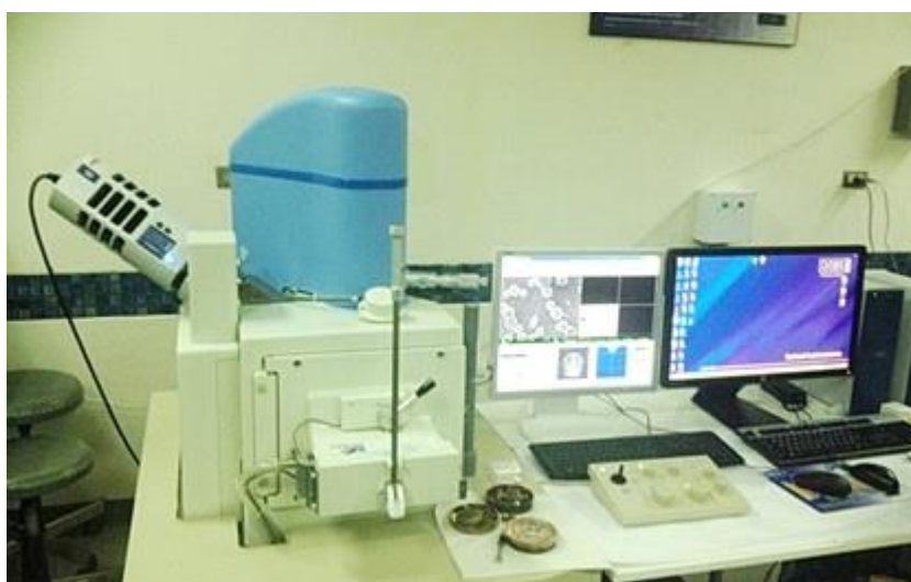
รูปที่ 3.21 Scanning electron microscope (SEM) ยี่ห้อ JEOL รุ่น JSM-6610LV
