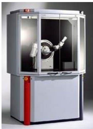
รูปที่ 3.17 X-ray diffractometer (XRD) ยี่ห้อ Bruker รุ่น D8 Advance
