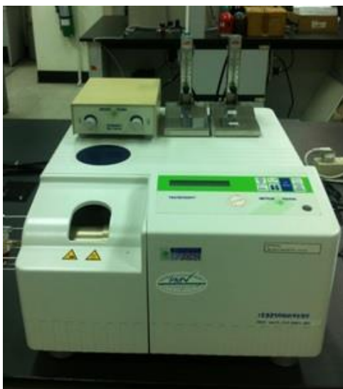
รูปที่ 3.23 Thermogravimetric analyzer ยี่ห้อ Mettler Toledo รุ่น 851e
