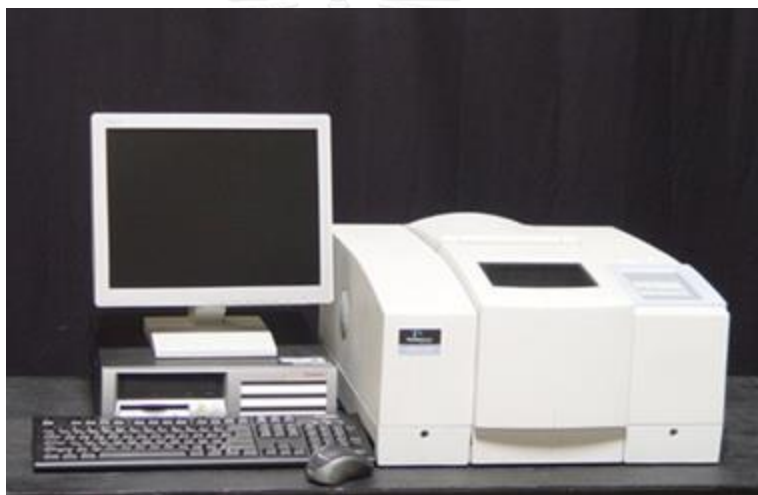
รูปที่ 3.11 Fourier transform infrared spectrometer (FT-IR) ยี่ห้อ Perkin Elmer รุ่น Spectrum One
