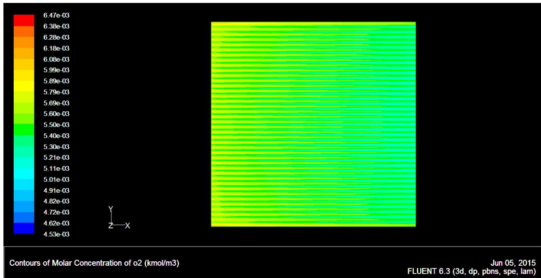
รูปที่ 4.29 การกระจายตัวของแก๊สออกซิเจนบนผิวรอยต่อระหว่างชั้นการกระจายตัวของแก๊สกับชั้นตัวเร่งปฏิกิริยา ที่ \eta_{act,c} = 0.1752 โวลต์ ที่อัตราการไหลขาเข้า 4.934 \times 10^{-4} กิโลกรัมต่อวินาที
