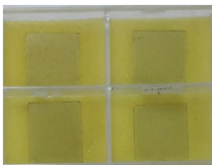
รูปที่ 3.7 ฟิล์มวัสดุเชิงประกอบ PEDOT:PSS/graphene/SDS/EG ที่เตรียมได้
