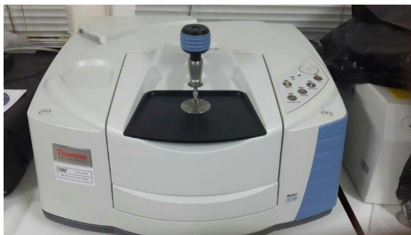
รูปที่ 3.8 เครื่องแอทเทนนูเอตโททัลรีเฟล็กชันฟูเรียร์ทรานส์ฟอร์มอินฟราเรดสเปกโทรมิเตอร์ (ATR-FTIR รุ่น Nicolet iS10)
