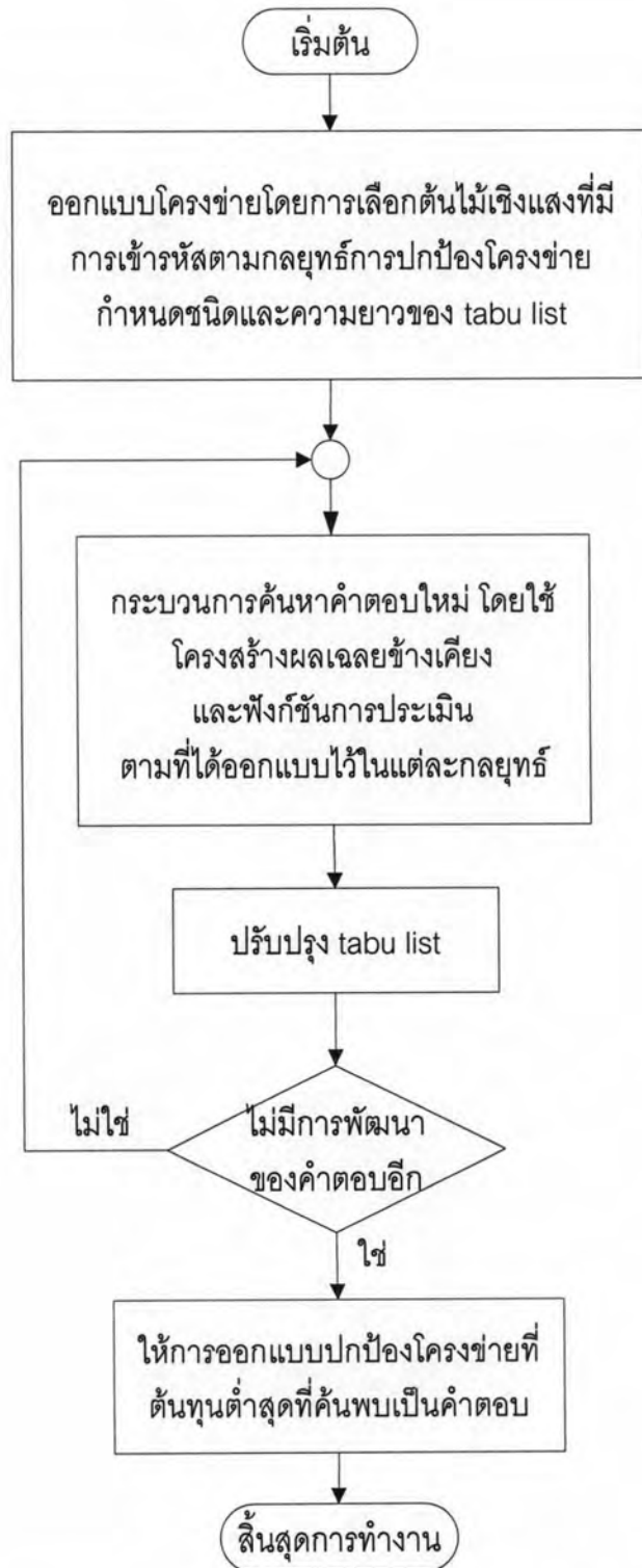
รูปที่ 3.2 ผังงานการจัดสรรความจุสำรองให้กับโครงข่าย ในแต่ละกลยุทธ์ด้วยอัลกอริทึมฮิวริสติกที่อยู่บนพื้นฐานการค้นหาแบบทาบู
