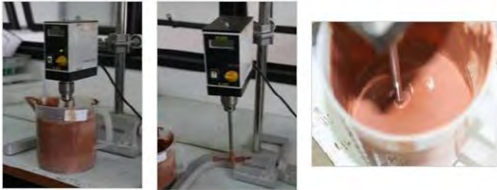
รูปที่ 3.1 เครื่องปั่นกวนน้ำดินและวิธีกวนผสมน้ำดิน
