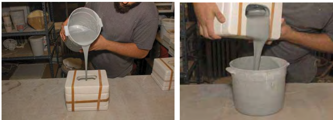
รูปที่ 2.6 รูปแสดงวิธีหล่อน้ำดิน
