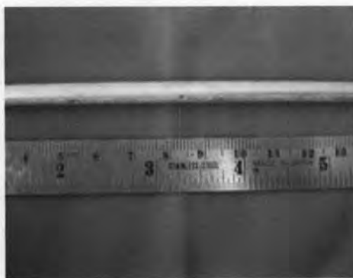
รูปที่ 4.1 ภาพแสดงชิ้นงานหลังหล่อด้วยกระบวนการหล่อแบบต่อเนื่องของโลหะผสมเงินเกรด 940 ขนาดเส้นผ่านศูนย์กลาง 5.5 มิลลิเมตร
