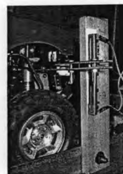
รูปที่ 8.11 การทดลองหาค่า K ของยานพาหนะ
