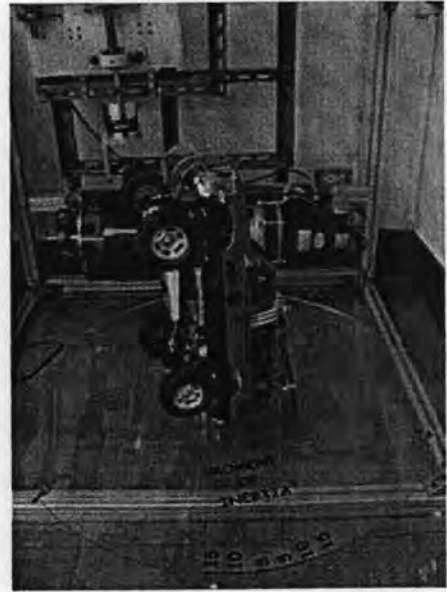
รูปที่ 8.2 การหาค่า โมเมนต์ความเฉื่อยของตัวยานพาหนะรอบแกน y (ซ้าย) และแกน x (ขวา)
