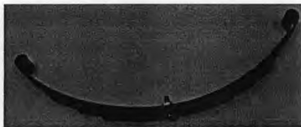
รูปที่ 8.8 แหนบ 5 แผ่นก่อนทำการแยกชิ้น
