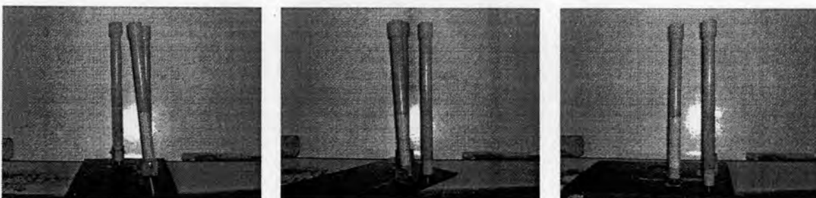
รูป ก-17 แบบจำลองต่อม่อ กรณีเสาชิมเอียงจากแนวตั้ง 5^\circ ในระนาบตั้งฉากกับทิศทางการไหล (B3)
