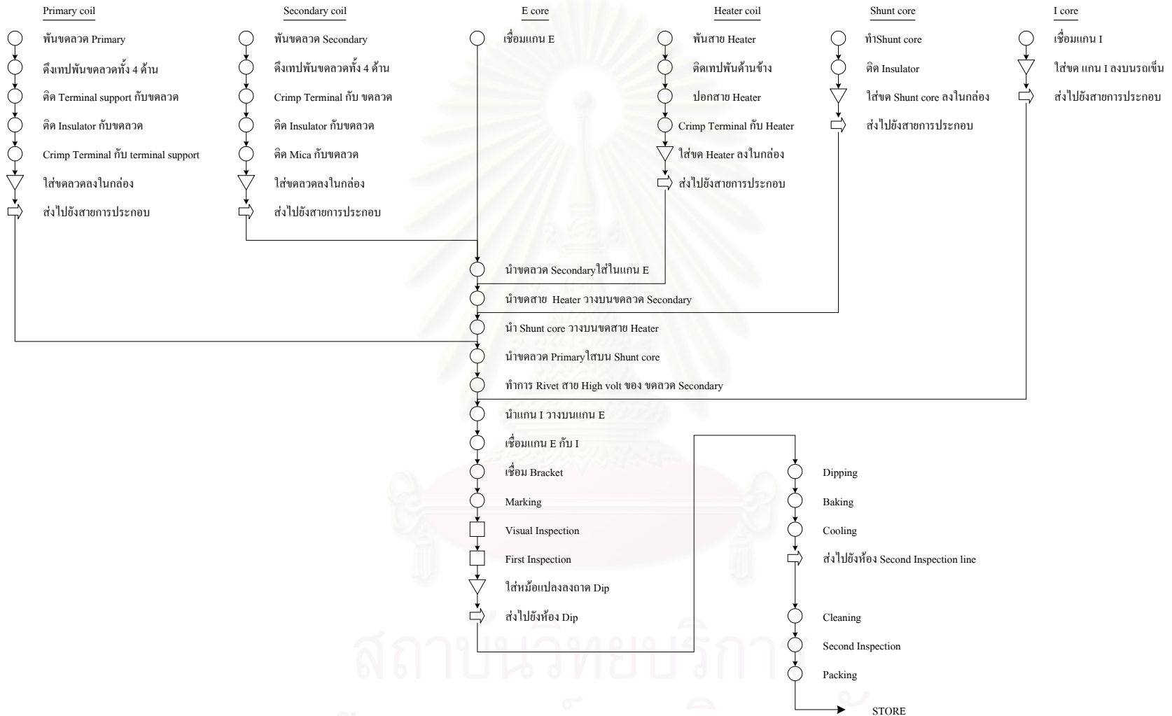
แผนภาพที่ 3.1 : แสดงขั้นตอนการผลิตหม้อแปลงของแผนก ERL
