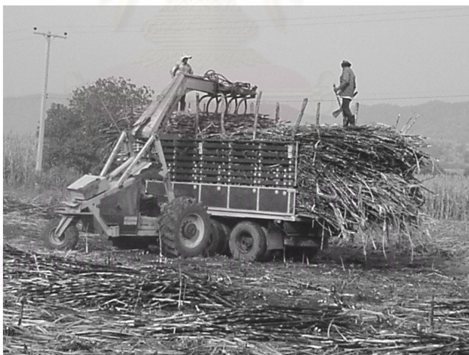
ภาพที่ 3.7 ลักษณะรถคืบชนิดสามล้อ (เบลล์) และวิธีการทำงาน
