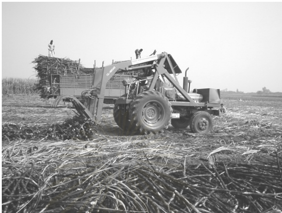
ภาพที่ 3.6 ลักษณะรถคืบหลังและวิธีการทำงาน
