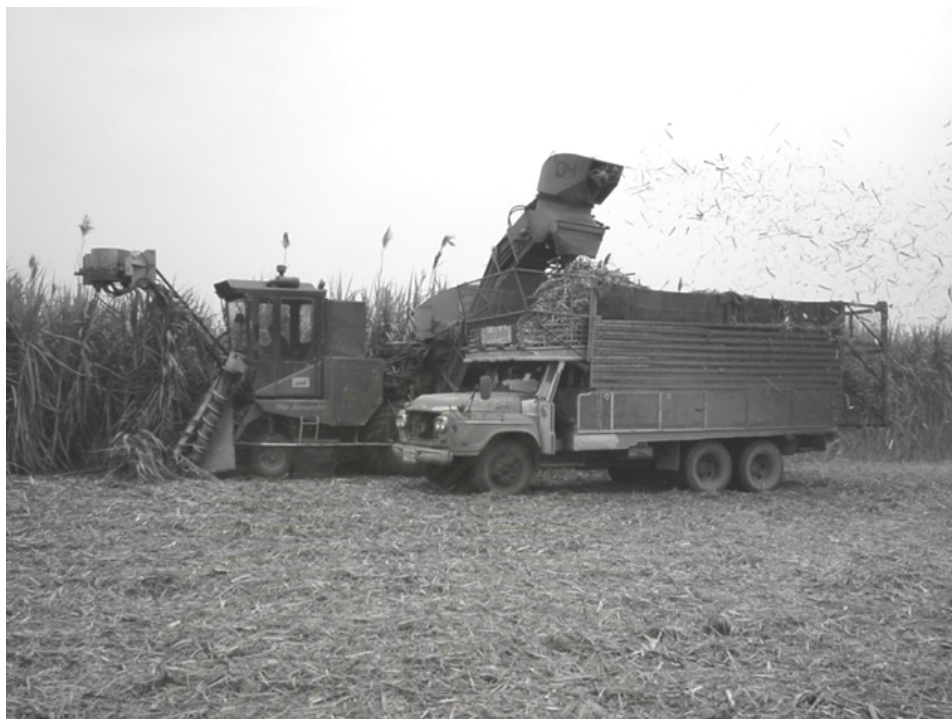
ภาพที่ 3.8 ลักษณะรถตัดอ้อย และวิธีการทำงาน
