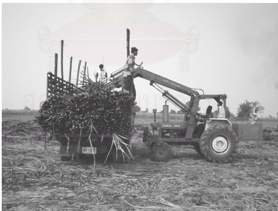
ภาพที่ 3.5 ลักษณะรถคืบหน้าและวิธีการทำงาน
