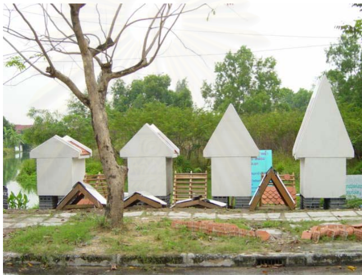
(ค) แสดงการติดตั้งโครงหลังคาไม้ลงบนผนังหุ่นจำลอง
