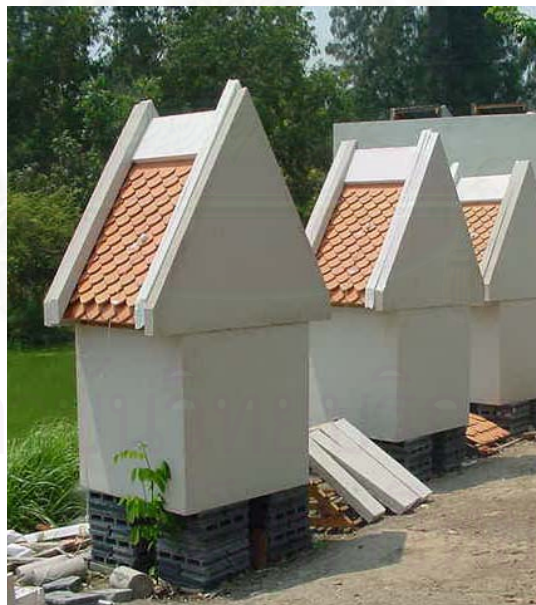
รูป 3-28 แสดงลักษณะของหุ่นจำลอง เพื่อทดสอบตัวแปร Insulation
