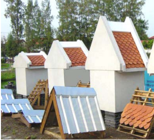
รูป 3-20 แสดงลักษณะของหุ่นจำลอง เพื่อทดสอบตัวแปร Stratification
