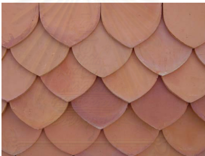
รูป 3-7 แสดงกระเบื้องมุงหลังคาที่ใช้ในการวิจัย เป็นกระเบื้องหางมน ชนิดไม่เคลือบผิว สีธรรมชาติ
