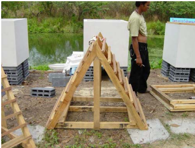
รูป 3-6 แสดงโครงหลังคาไม้ที่ใช้ในการวิจัย
