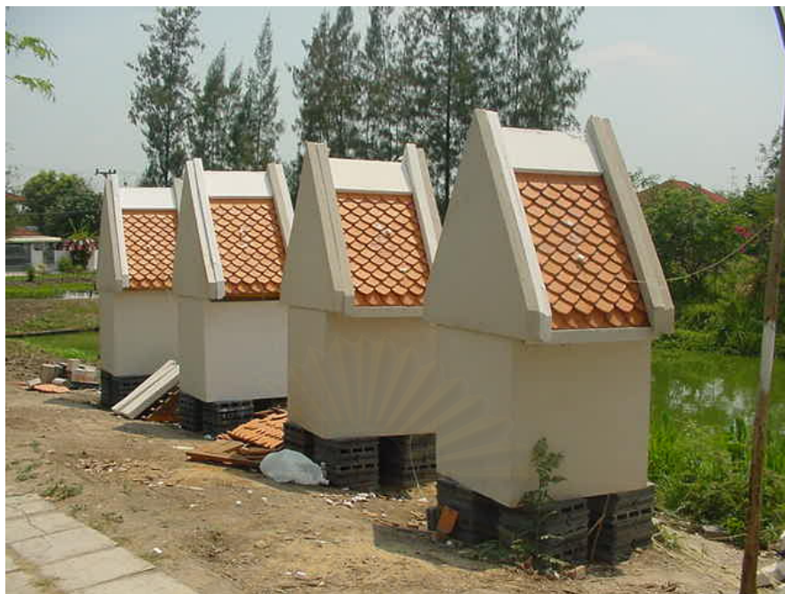
รูป 3-26 แสดงลักษณะของหุ่นจำลอง เพื่อทดสอบตัวแปร Ventilation
