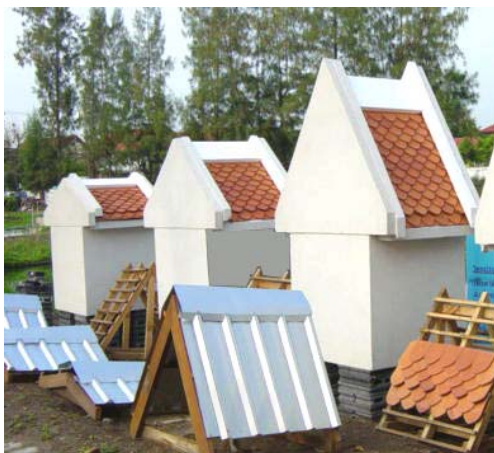
รูป 3-16 แสดงลักษณะของหุ่นจำลอง เพื่อทดสอบตัวแปร Solar radiation และ Long-wave radiation
