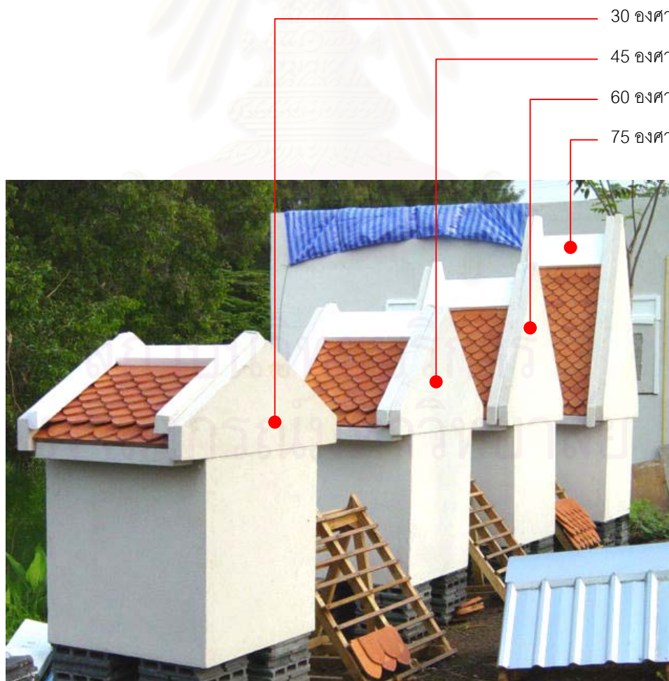
รูป 3-22 แสดงลักษณะของหุ่นจำลอง เพื่อทดสอบตัวแปร Mean radiant temperature
