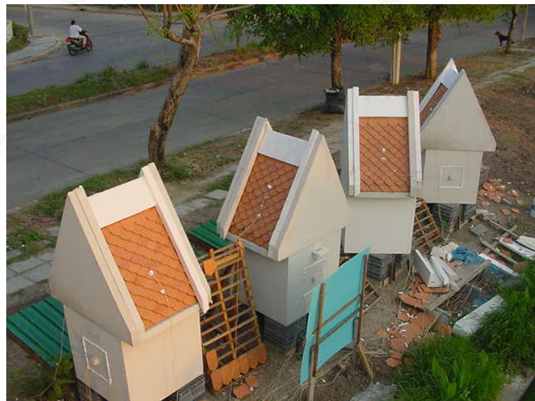
รูป 3-18 แสดงลักษณะของหุ่นจำลอง เพื่อทดสอบตัวแปร Orientation
