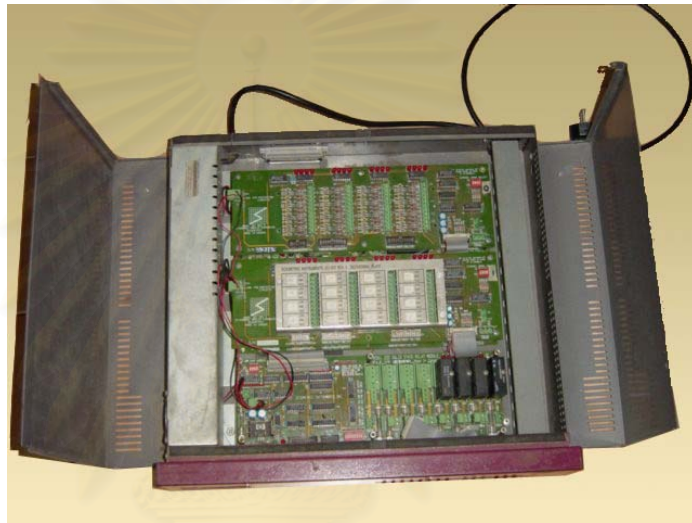
รูป 3-10 แสดงเครื่องมือเก็บค่าอุณหภูมิ Data Logger System 200
