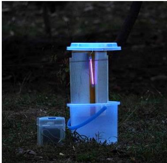
ภาพที่ 32 ก๊ับดักแสงไฟแบบ Mobile light trap
