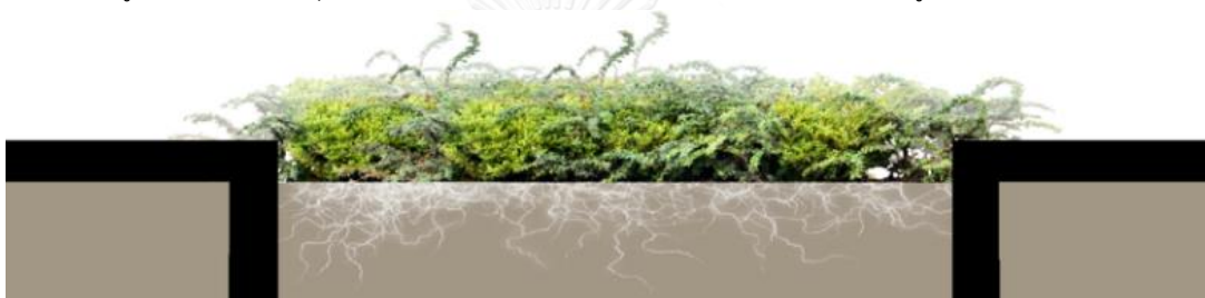
รูปที่ 75 รูปตัดแสดงการควบคุมขอบเขตการเจริญเติบโตของวัชพืชด้วยการเจาะช่องปลูกบนพื้นลาดแข็ง
