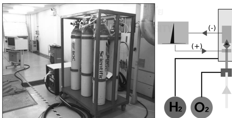
รูปที่ ข.8 เครื่องตรวจวัดก๊าซ CH 4 และหลักการทำงานของ FID
