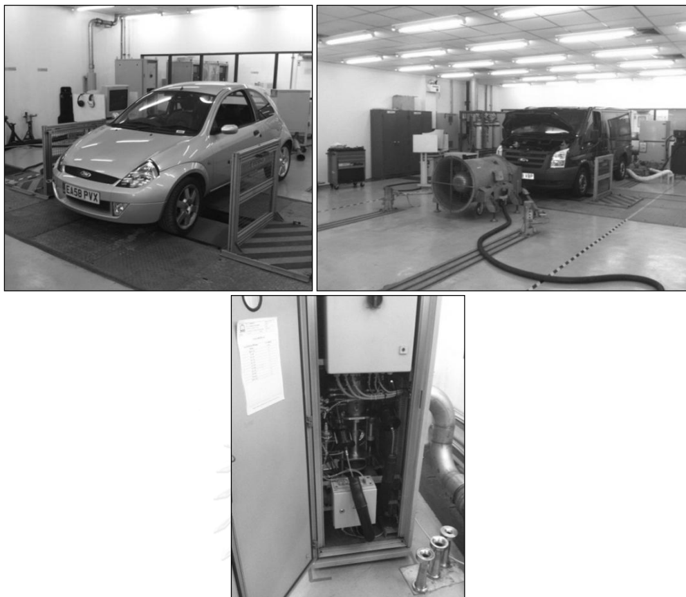
ภาพที่ ข.6 ระบบแอสซิไซด์ไนโตรเจนและพัดลมระบายความร้อน และระบบเก็บตัวอย่างด้วยการเจือจางไอเสีย (CVS)
