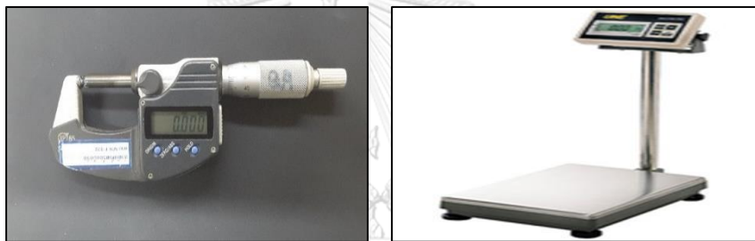
รูปที่ 4.9 แสดงเครื่องมือในการวัดความหนาและน้ำหนักของท่อ
