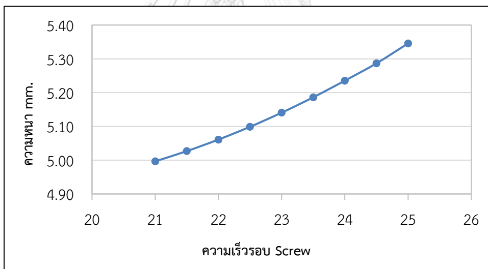
รูปที่ 5.4 แสดงความสัมพันธ์ของความเร็วรอบ Screw กับความหนาท่อ
