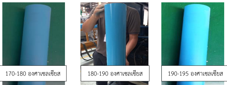
รูปที่ 5.3 แสดงลักษณะผิวของท่อพีวีซีเมื่อปรับอุณหภูมิปลายแม่พิมพ์ไปที่ระดับต่างๆ
