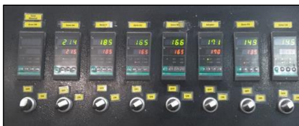
รูปที่ 7.2 หน้าจอแสดงผลควบคุมอุณหภูมิหัวและท้ายแม่พิมพ์
