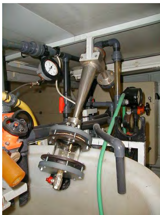
รูปที่ 3.7 การติดตั้งกริตพอทที่ทางออกด้านล่างของไฮโดรไซโคลขนาด 75 มิลลิเมตร
