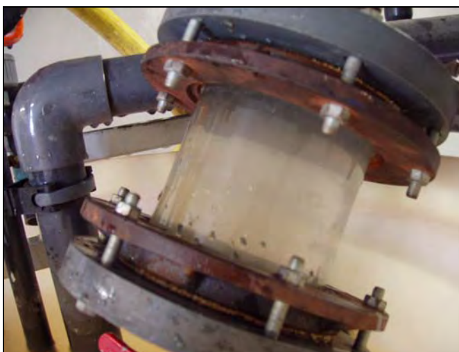
รูปที่ 4.15 ความเข้มข้นสารแขวนลอยในกริตพอทที่เริ่มต้นการทดลองเมื่อทดลองด้วยไฮโดรไซโคลนขนาดเส้นผ่านศูนย์กลาง 75 มิลลิเมตร ความดัน 1.0 บาร์
