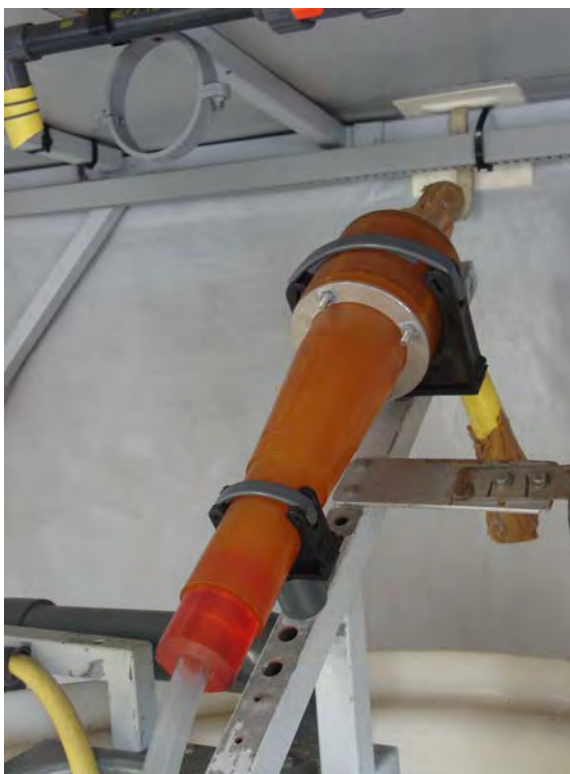
รูปที่ 3.2 ไฮโดรไซโคลนเส้นผ่านศูนย์กลางขนาด 50 มิลลิเมตร
