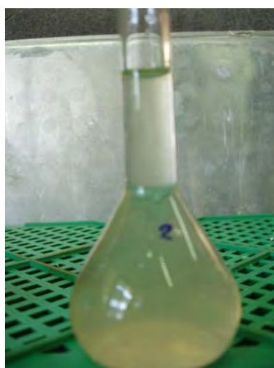
รูปที่ 4.17 ความเข้มข้นสารแขวนลอยที่แยกออกทางด้านบนด้วยไฮโดรไซโคลนแบบธรรมดา
