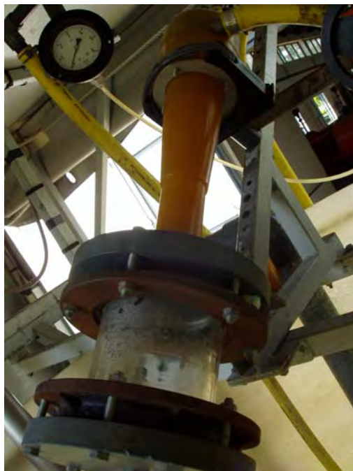
รูปที่ 3.6 การติดตั้งกริตพอทที่ทางออกด้านล่างของไฮโดรไซโคลขนาด 50 มิลลิเมตร
