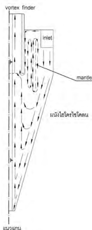
รูปที่ 2.3 เส้นทางไหลของน้ำที่ทางออกในแนวนานและการไหลในแนวรัศมี ภายในไฮโดรไซโคลนแบบทั่วไป (Svarovsky, 1984)
