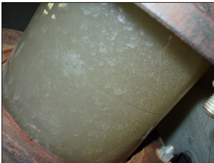
รูปที่ 4.16 ความเข้มข้นสารแขวนลอยที่สะสมตัวอยู่ในกริดพอทเมื่อเวลาผ่านไป 5.45 ชั่วโมง เมื่อทดลองด้วยไฮโดรไซโคลนขนาดเส้นผ่านศูนย์กลาง 75 มิลลิเมตร ความดัน 1.0 บาร์
