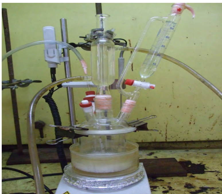
รูปที่ 3.3 การติดตั้งเครื่องปฏิกรณ์ เครื่องควบคุม และท่อ นำแก๊ส
