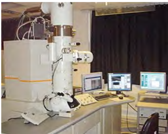
รูปที่ 3.23 เครื่อง Scanning electron microscopy รุ่น JEOL JSM-6400
