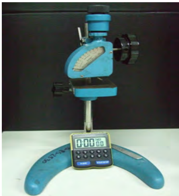
รูปที่ 3.18 เครื่องทดสอบความแข็งแบบ Shore A durometer hardness system shore A
