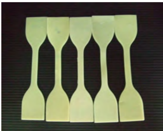
รูปที่ 3.15 ชิ้นงานรูปดัมเบลล์ของนาโนคอมพอสิตของพอลิไทรีน/ซิลิกา/ยางธรรมชาติ
