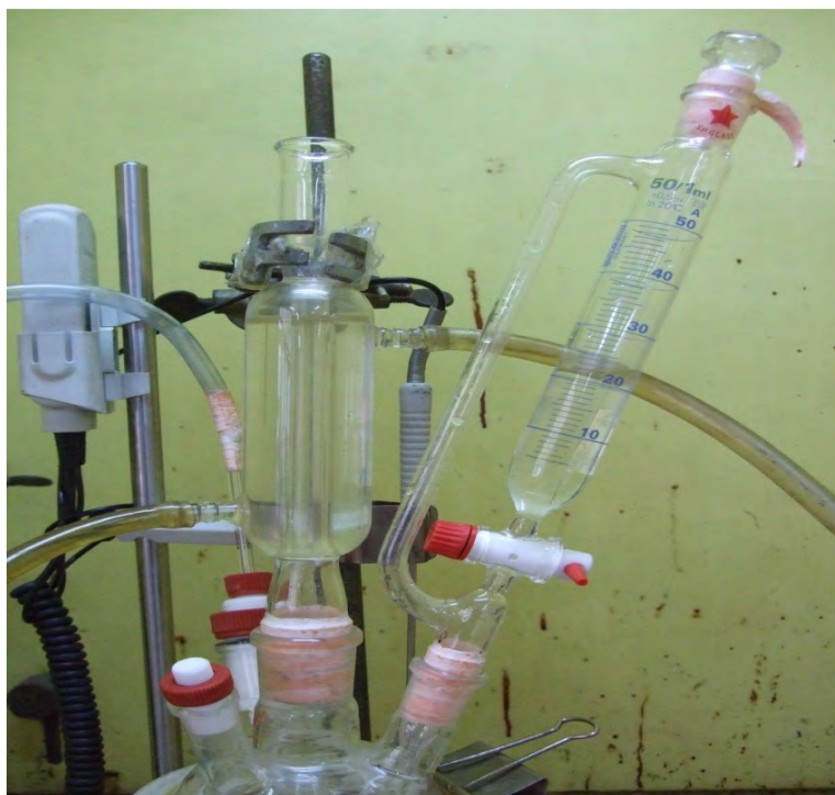
รูปที่ 3.4 การติดตั้ง dropping funnel เพื่อหยดสไตรีนมอนอเมอร์
