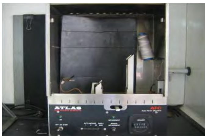
รูปที่ 3.21 เครื่องทดสอบ Atlas 45° automatic flammability tester
