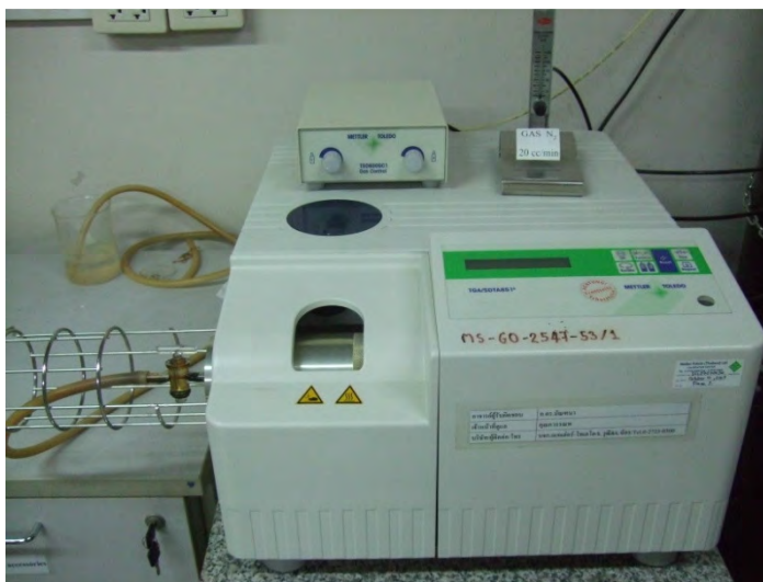
รูปที่ 3.19 เครื่อง Thermogravimetric analyzer ของ METTLER TOLEDO รุ่น TGA/SDTA 851°
