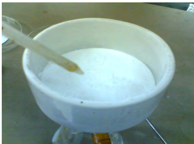
รูปที่ 3.6 การล้างและกรองอนุภาคระดับนาโนที่เตรียมได้ด้วยเครื่องกรองสุญญากาศ
