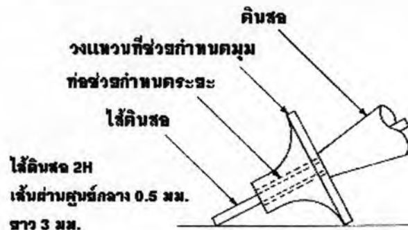
รูปที่ 4.2 แสดงอุปกรณ์ช่วยกำหนดมุมตามมาตรฐานเอเอสทีเอ็ม ซี97
