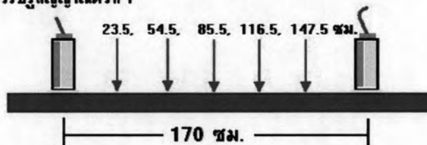
รูปที่ 4.5 ตำแหน่งสำหรับการทดสอบบนท่อยาว 2 เมตรในการทดลองครั้งที่ 1
