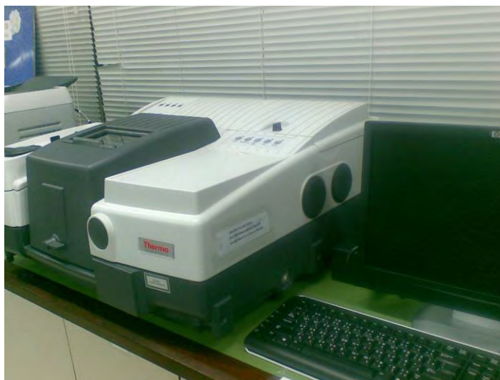
รูปที่ 3.6 เครื่องฟูเรียร์ทรานส์ฟอร์มอินฟราเรดสเปกโทรมิเตอร์ (FT-IR) รุ่น Nicolet 6700
