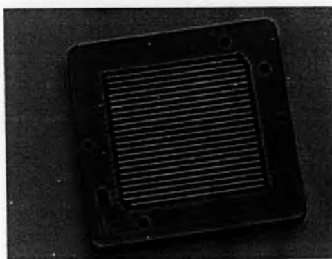
รูปที่ 3.3 ลักษณะช่องทางการไหลในแผ่นนำไฟฟ้าสองขั้วที่ใช้ในชั้นเซลล์เชื้อเพลิงพีซีเอ็ม
