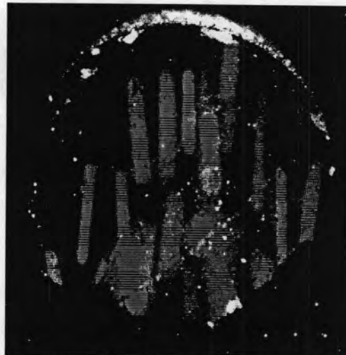
รูปที่ 3.5 ตัวอย่างภาพการเคลื่อนที่ของเม็ดแก้วที่บันทึกได้จากเทคนิค PIV
