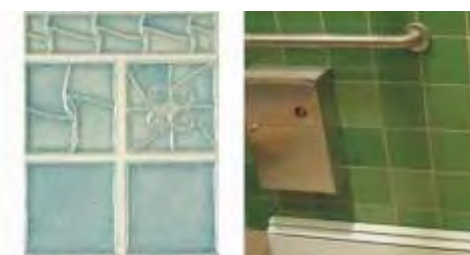
ภาพที่ 2.16 กระเบื้องกลาสเซรามิกที่ผลิตจากการเศษแก้วรีไซเคิลเหลือทิ้ง (Holand และ Beall, 2002)
