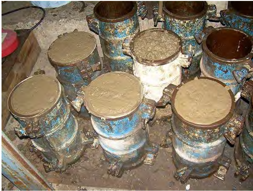
รูปที่ 4.13 การเก็บตัวอย่างคอนกรีต
