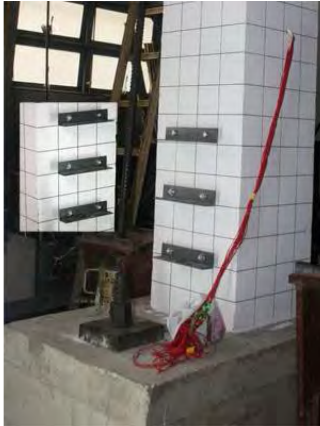
รูปที่ 4.18 การติดตั้งเหล็กสำหรับจับยึดเครื่องวัดระยะเคลื่อนที่
