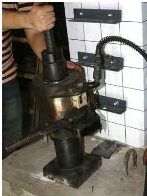
รูปที่ 4.19 การใช้อุปกรณ์ยึดติดฐานรากด้วยวิธีอัดแรง
