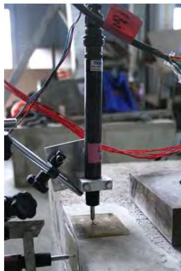
รูปที่ 4.26 การติดตั้งเครื่องวัดระยะเคลื่อนที่ที่ใช้วัดการหมุนของฐานราก
