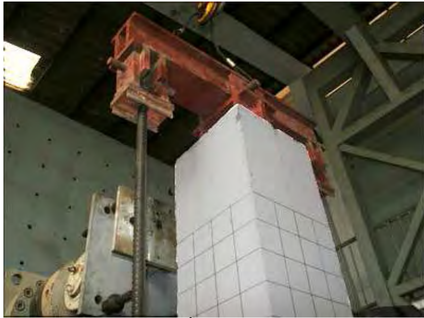
รูปที่ 4.20 การติดตั้งคานเหล็กให้แรงในแนวตั้ง
