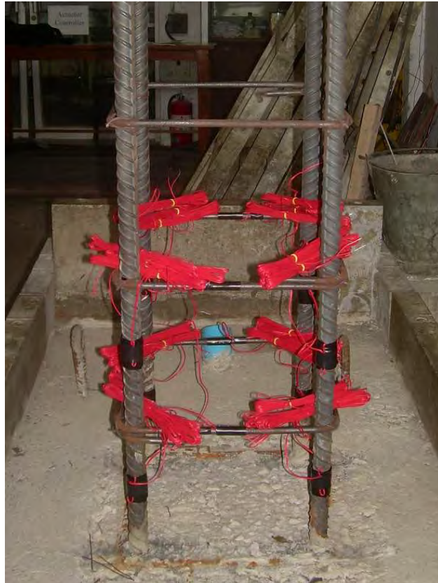
รูปที่ 4.11 ลักษณะการเสริมเหล็กของตัวอย่างเสา C-09-200
