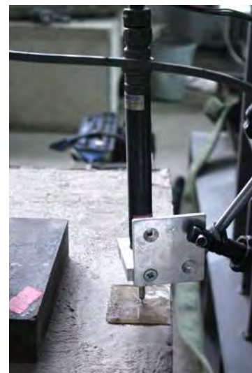
รูปที่ 4.26 การติดตั้งเครื่องวัดระยะเคลื่อนที่ที่ใช้วัดการหมุนของฐานราก
