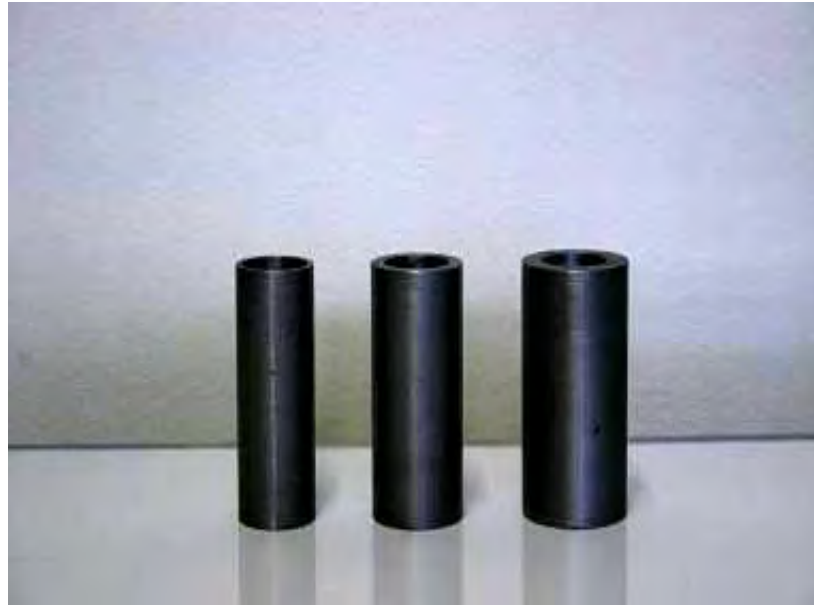
รูปที่ 3.3 ปลอกยี่ดิ่งเหล็กเสริมที่แปรความหนา
