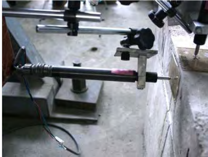
รูปที่ 4.27 การติดตั้งเครื่องวัดระยะเคลื่อนที่ที่ใช้วัดการเคลื่อนที่ของฐานราก
