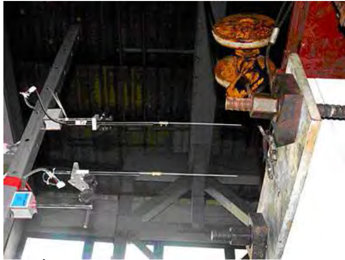
รูปที่ 4.24 การติดตั้งเครื่องวัดระยะเคลื่อนที่ใช้วัดการเคลื่อนที่ด้านข้างของตัวอย่างเสา
