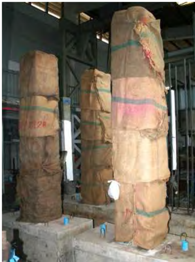
รูปที่ 4.14 การใช้กระสอบเปียกบ่มตัวอย่างเสา
