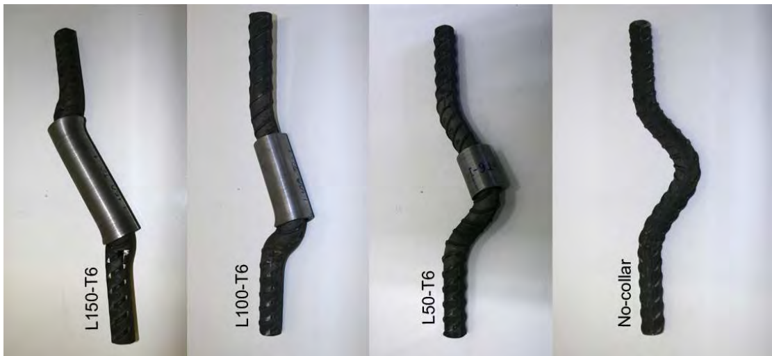
รูปที่ 3.8 รูปแบบการวิบัติของตัวอย่างปลอกยึดรั้งเหล็กเสริมซึ่งแปรผันขนาดความยาว
