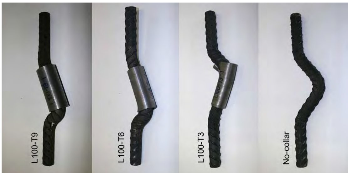
รูปที่ 3.9 รูปแบบการวิบัติของตัวอย่างปลอกยึดรั้งเหล็กเสริมซึ่งแปรผันขนาดความหนา
