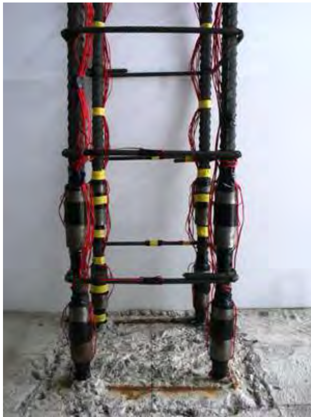
รูปที่ 4.10 ลักษณะการเสริมเหล็กของตัวอย่างเสา CC-09-200
