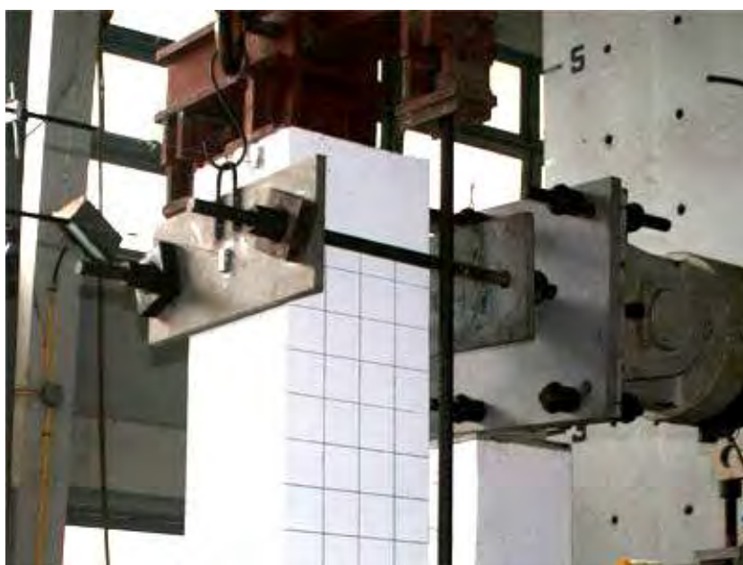
รูปที่ 4.22 การติดตั้งแผ่นเหล็กยึดติดกับเหล็กส่วนหน้าของเครื่องให้แรงในแนวราบ
