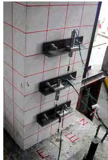
รูปที่ 4.25 การติดตั้งเครื่องวัดระยะเคลื่อนที่ที่ใช้วัดการหมุนบริเวณโคนเสา
