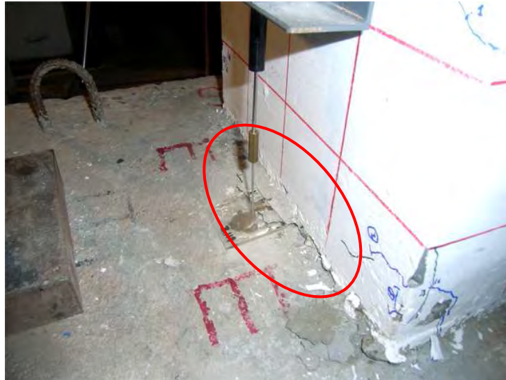
รูปที่ 5.25 การหลุดร่อนของกระเบื้องรองเครื่องวัดระยะเคลื่อนที่
