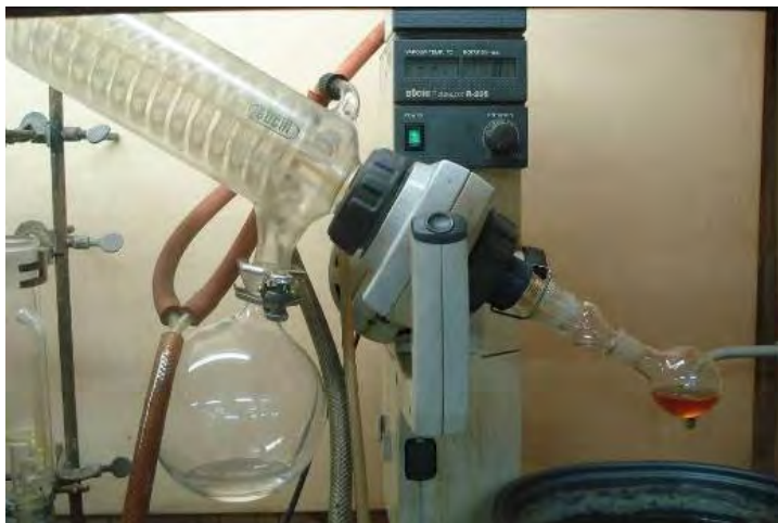
รูปที่ 3.2 การระเหยสารสกัดฆ่าออกจากเอทานอลด้วยเครื่อง rotary evaporator
