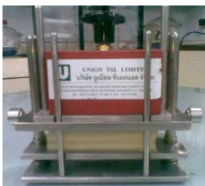
รูปที่ 3.8 เครื่อง perspirometer ที่ใช้ในการทดสอบความคงทนของสารต้านจุลินทรีย์บนผ้าฝ้ายต่อเหงื่อ
