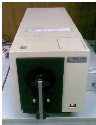
รูปที่ 3.11 เครื่องวัดสีของ Macbeth Color-Eye 7000 ที่ใช้ในการวัดความขาวของผ้าฝ้าย
