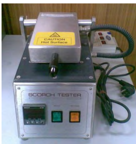
รูปที่ 3.9 เครื่องรีดร้อน (scorch tester) ที่ใช้ในการทดสอบของสารต้านจุลินทรีย์บนผ้าฝ้ายต่อการรีดร้อน
