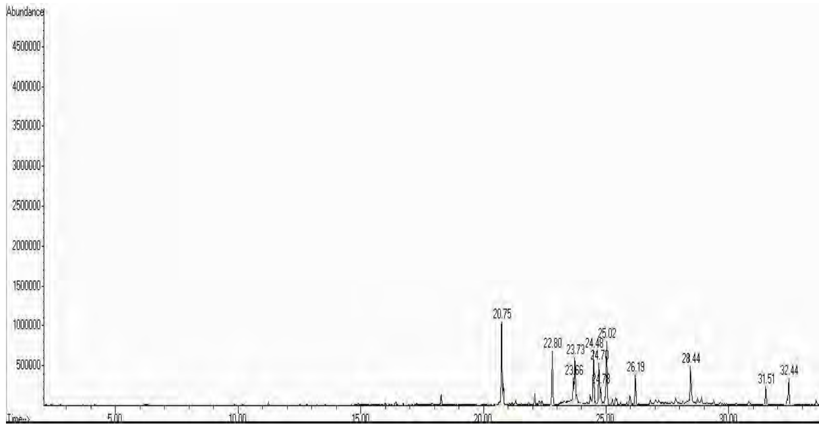
รูปที่ ข.4 โครมาโตแกรมจาก GC-MS ของสารสกัดข้าวแห้งสกัดด้วยเอทานอลที่อุณหภูมิ 60 องศาเซลเซียส เป็นเวลา 45 นาที
