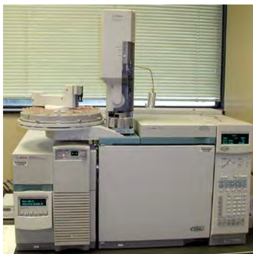
รูปที่ 3.4 เครื่อง GC-MS ที่ใช้ในการวิเคราะห์องค์ประกอบทางเคมีของสารสกัดชาที่เตรียมได้ [27]
