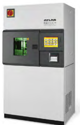
รูปที่ 3.7 เครื่อง Atlas Xenon Arc Weather-Ometer ที่ใช้ในการอบแสง [28]
