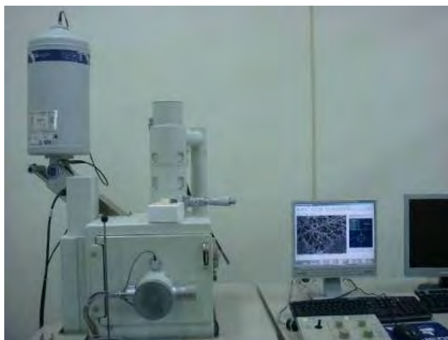
รูปที่ 3.10 เครื่อง SEM ที่ใช้ในการศึกษาลักษณะทางสัณฐานวิทยาพื้นผิวของผ้าฝ้าย
