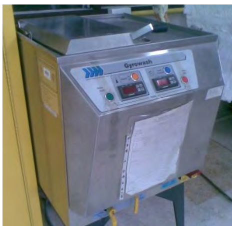
รูปที่ 3.6 เครื่อง Gyrowash ที่ใช้ในการซักล้างผ้าฝ้าย
