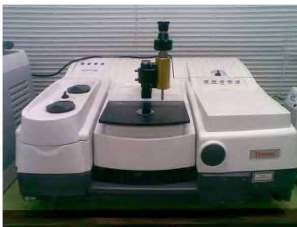
รูปที่ 3.5 เครื่อง ATR-FTIR ที่ใช้ในการวิเคราะห์โครงสร้างทางเคมีของผ้าฝ้ายที่ตกแต่งด้านจุลินทรีย์ก่อนและหลังซัก
