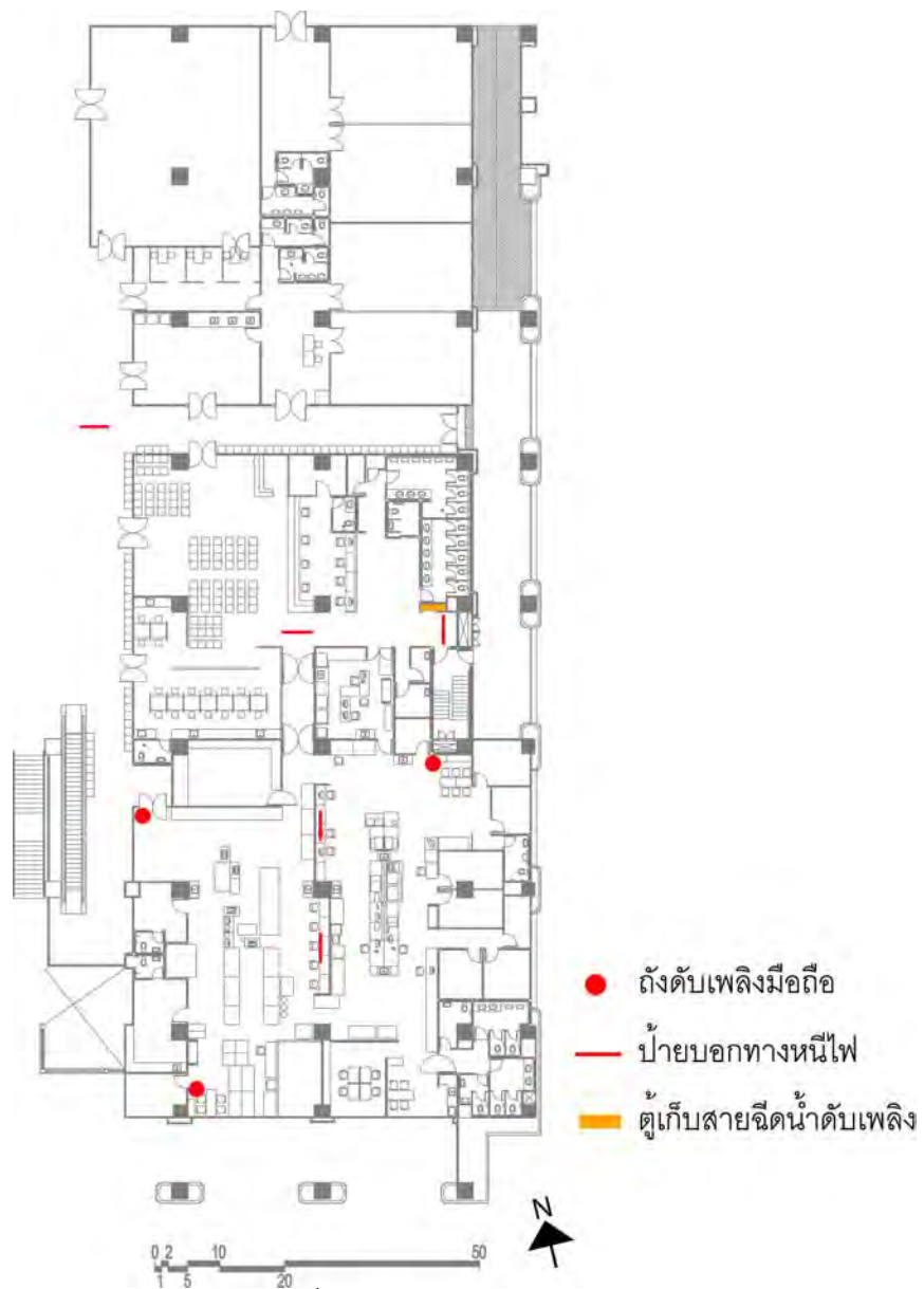
รูปที่ 5-53 ตำแหน่งอุปกรณ์ดับเพลิง
