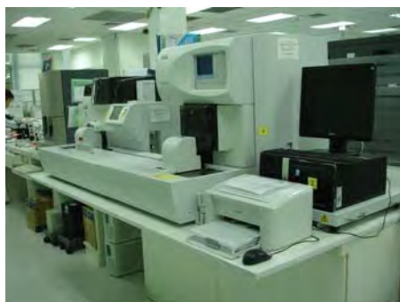
รูปที่ 6-16 โต๊ะวางเครื่องวิเคราะห์อัตโนมัติที่มีความกว้างไม่เพียงพอ
