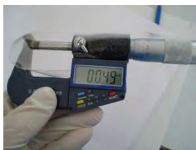
ภาพที่ 4.2.4 ตัวอย่างการวัดความหนาของแผ่นฟิล์ม
