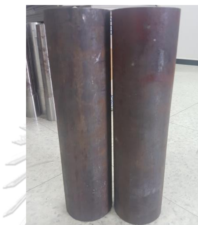
รูปที่ 3.1 เหล็กกล้าคาร์บอนเกรด S45C
